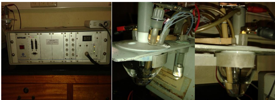
Figura 13: Imagens ilustrativas do equipamento, sendo a primeira imagem correspondente ao AUTOLAB e as duas restantes à célula eletroquímica.
