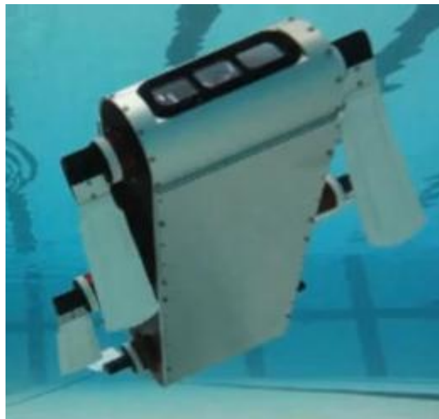
Figura 21 Robô nadador controlado por um iPad [21]
