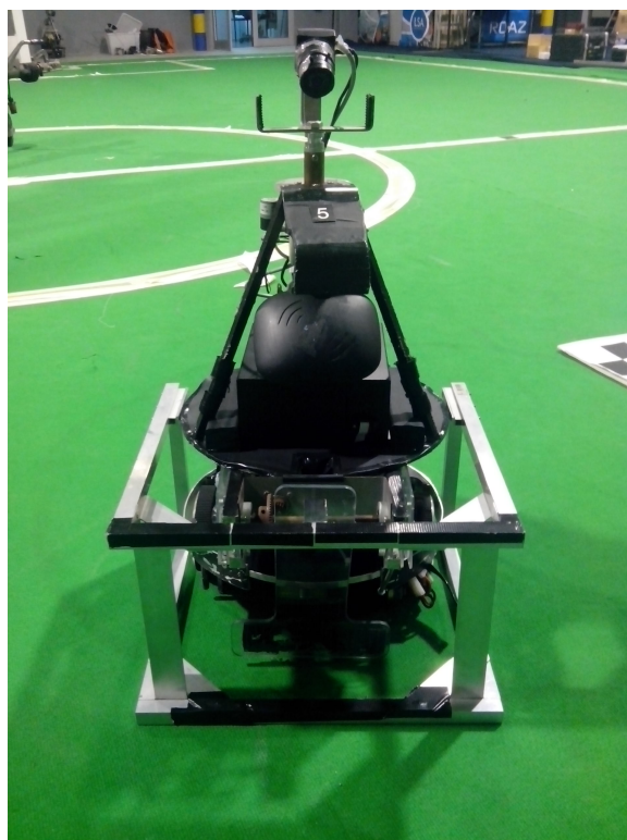
Figura 5.4: Alinhamento manual dos ângulos do robô usando a frame mecânica
