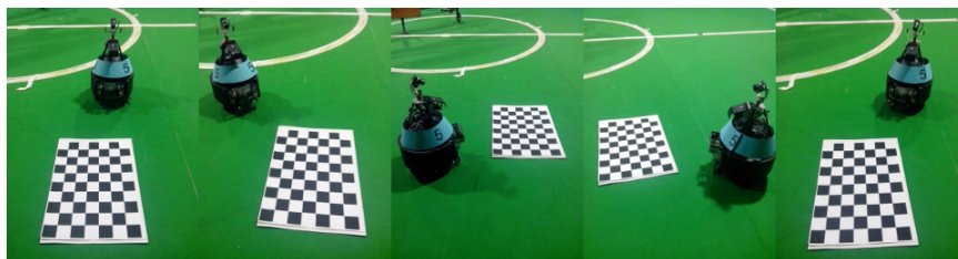
Figura 7.1: Imagens do robô a realizar a manobra circular em torno do alvo.
