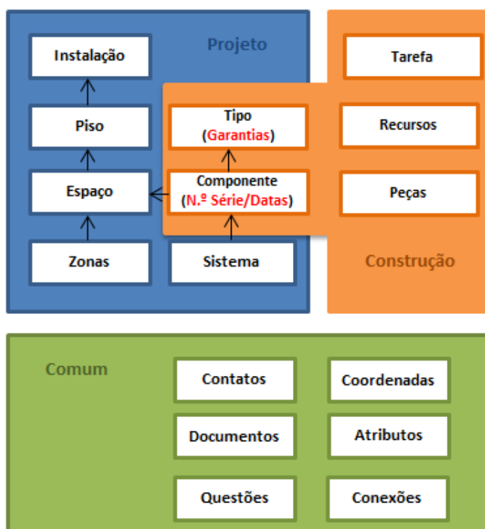
Fig. 32 - Esquema de recolha de dados COBie do modelo na fase operação, adaptado de (B. East, 2011).
