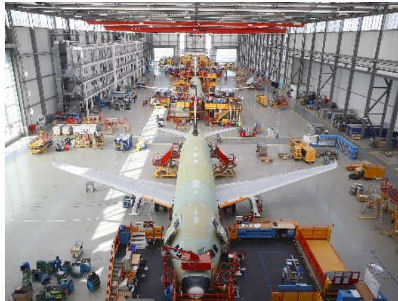
Figura 19- Layout posição fixa
