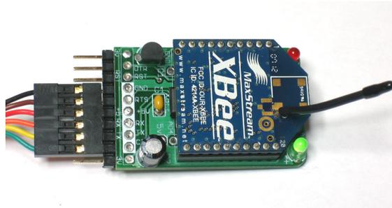
**Fig. 6.9:** Adaptador com o módulo XBee e cabo FTDI conectados.
