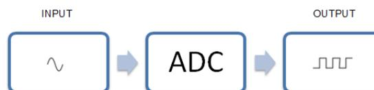
**Fig. 4.12:** Representação esquemática de um conversor analógico-digital (ADC).
