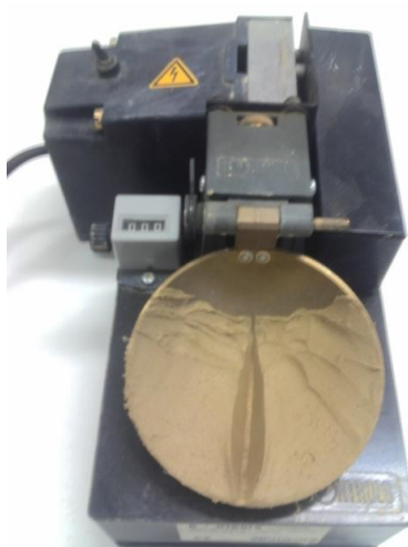
Fig. 28: Determinação do limite de liquidez – Concha de Casagrande.
