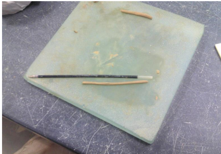
Fig. 29: Determinação do limite de plasticidade – método tradicional.
