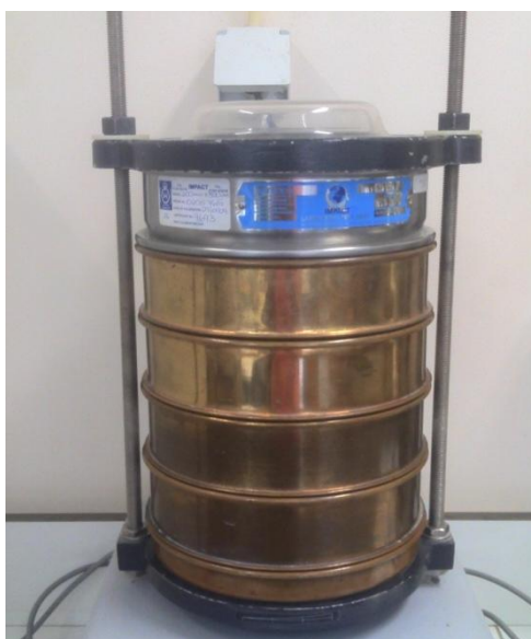
Fig. 24: Peneiração mecânica do material retido no peneiro 0,074mm.
