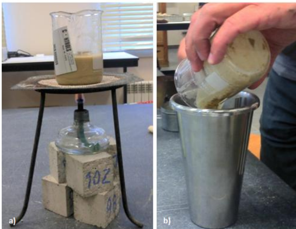
Fig. 22: a) Aquecimento da mistura; b) Colocação da mistura no recipiente de agitação.
