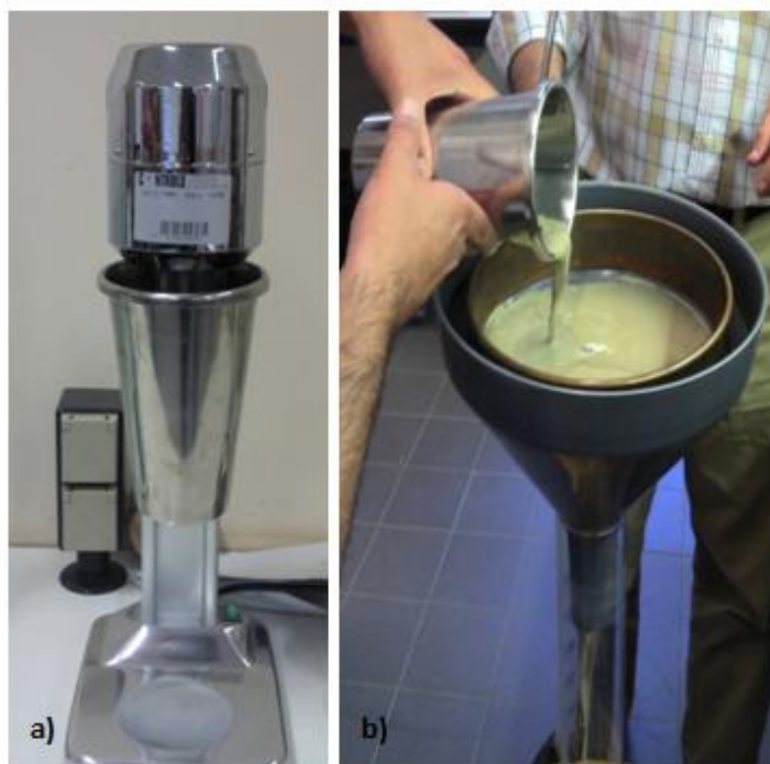
Fig. 23: a) Mistura em agitação; b) Transferência da mistura para o peneiro de 0,074mm.
