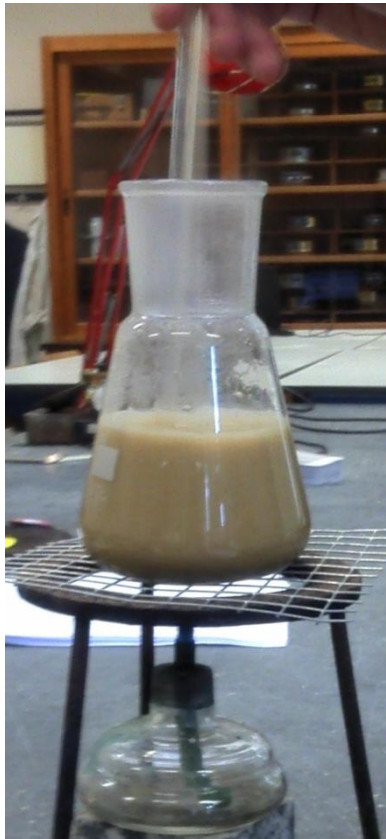
Fig. 18: Aquecimento e agitação da mistura de solo com água destilada.
