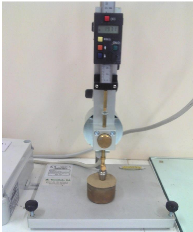
Fig.30: Determinação dos limites de consistência – Fall Cone.
