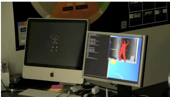
Figura 50 - Captura das articulações do corpo humano. À direita encontra-se a aplicação servidora OSCeleton; à esquerda a aplicação cliente, que recebe os valores transmitidos pelo OSCeleton e representa-os através de esferas [SenseBloom, 2011].
