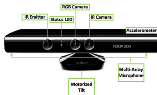
Figura 1 - Constituição do Microsoft Kinect [Mehlmann et al., 11]
