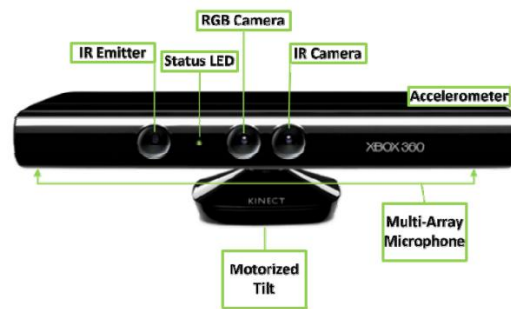
Figura 1 - Constituição do Microsoft Kinect [Mehlmann e tal., 2011].
