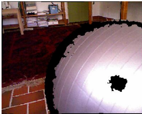
Figura 16 - Erro causado pela reflexão da luz solar numa bola de ginásio [Kjaer, 2011].
