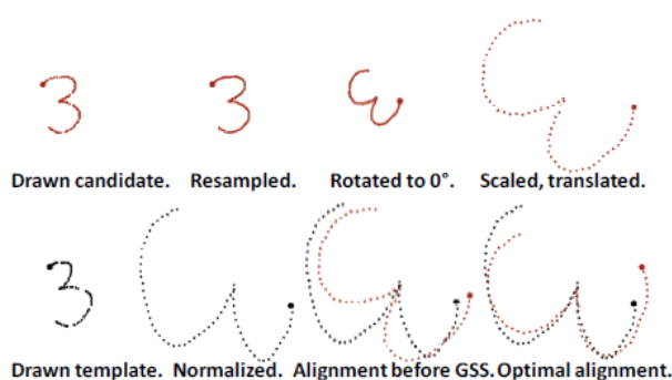
Figura 38 - Descrição dos passos de correspondência e alinhamento de um conjunto de pontos efetuado pelo \$1 [Anthony and Wobbrock, 2007b].
