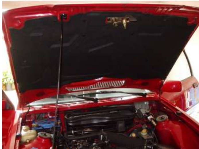
Figura 20 Exemplo de aplicação de adesivos estruturais epóxico-vinílico no forro do capô em automóveis [19].
