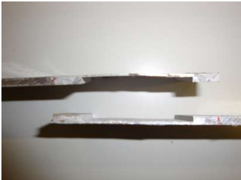
Figura 87 Superfície de rotura para a configuração JSS-15-10-1 (condição 2).
