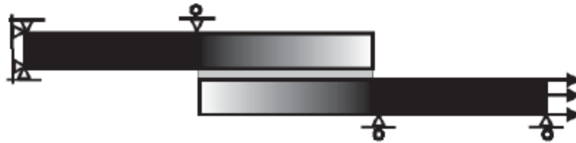
Figura 38 Juntas de sobreposição simples com graduação de E [38-39].
