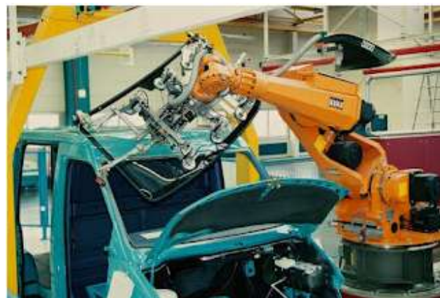
Figura 21 Exemplo de aplicação de adesivos estruturais epóxico-poliuretano na ligação entre o parabrisas e a carroceria em automóveis [20].
