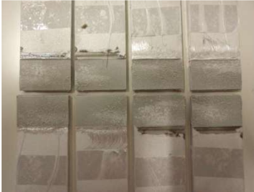
Figura 87 Superfície de rotura para a configuração JSS-15-10-1 (condição 2).
