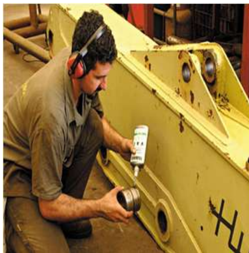
Figura 13 Exemplo de aplicação de adesivos estruturais acrílicos anaeróbicos em todo o tipo de peças cilíndricas [13].
