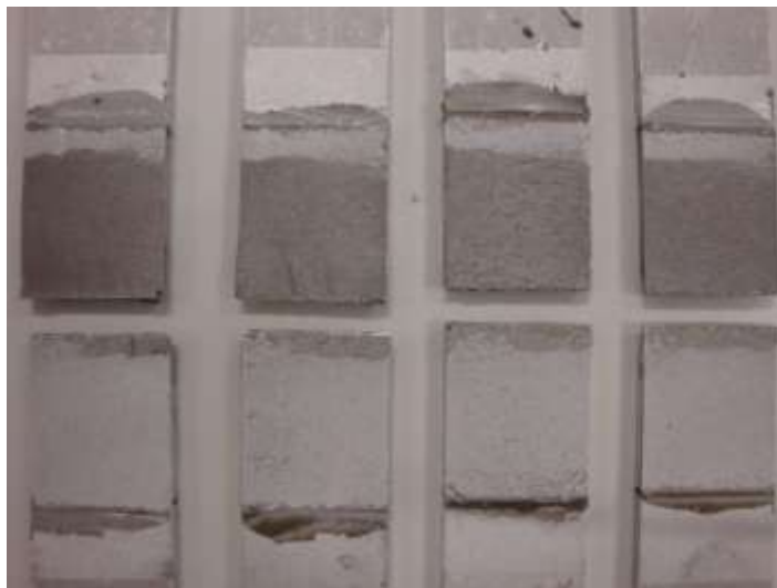
Figura 80 Superfícies de rotura para a configuração JSS-30-30-1 (condição 1).
