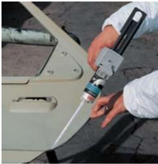
Figura 19 Exemplo de aplicação de adesivos estruturais epóxico-polisulfido nas juntas das portas em automóveis [19].
