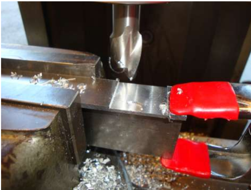
Figura 70 Rasgos nos substratos (condição 2) obtidos através do processo de fresagem.
