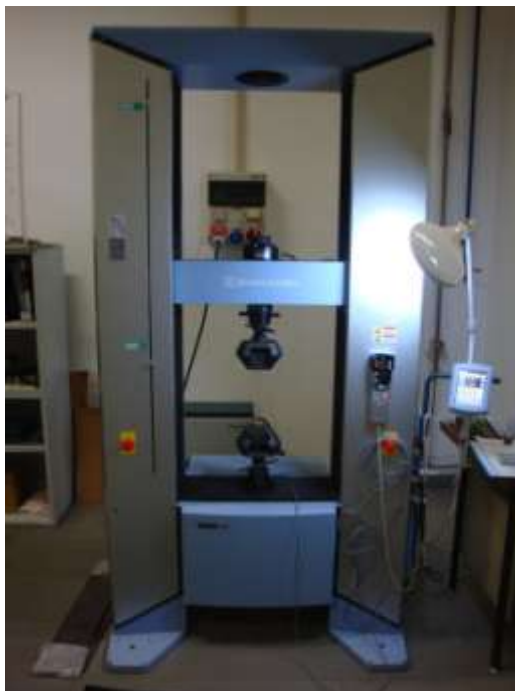
Figura 76 Máquina Shimadzu - Autograph AG-X utilizada para realização dos ensaios à tração.
