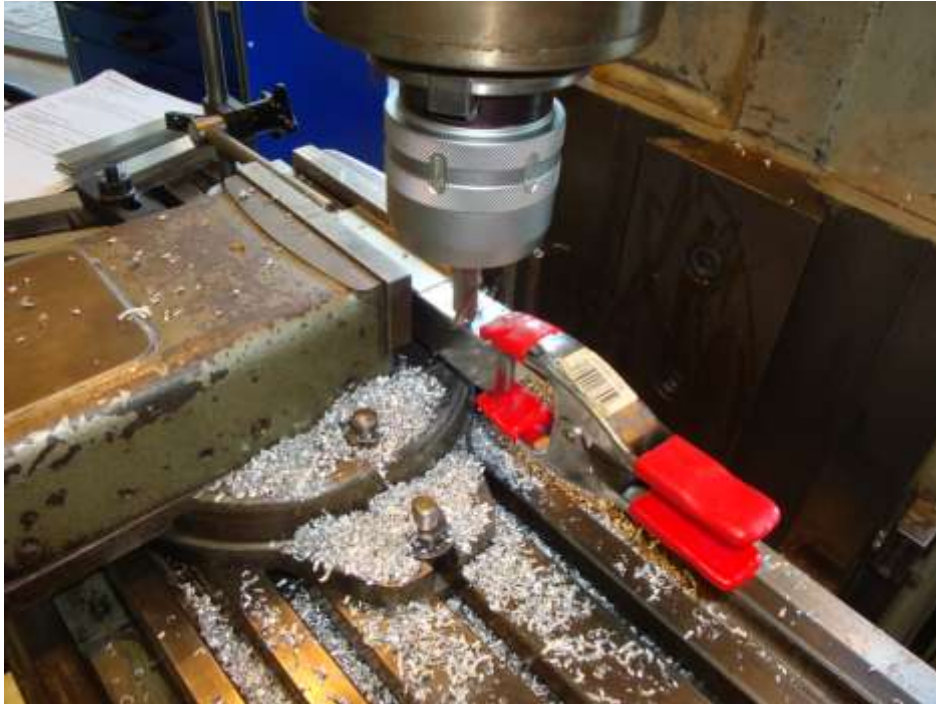
Figura 69 Processo de fresagem para obtenção dos rasgos nos substratos (condição 2).
