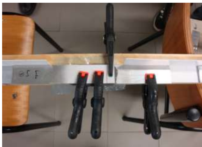
Figura 73 Aspeto das juntas após o processo de montagem.
