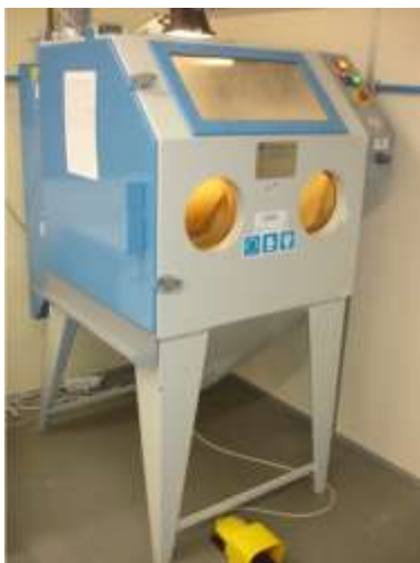
Figura 71 Granalhadora SABBIATRICE Sand Blaster utilizada para efetuar a granalhagem.
