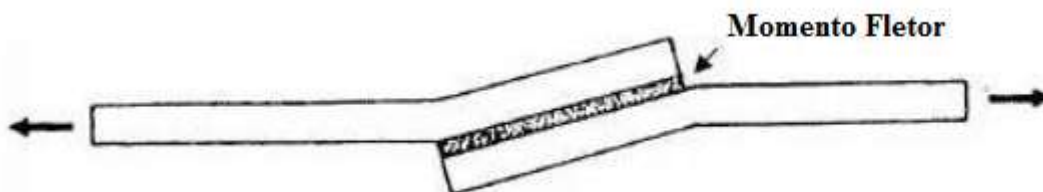
Figura 11 Representação geométrica do fator momento fletor numa junta sobreposição simples [8].
