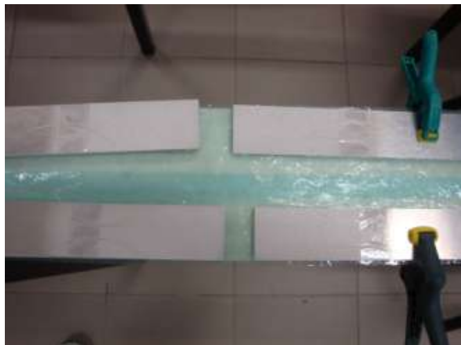
Figura 72 Aspeto dos substratos previamente colocados na barra de suporte com grampos de mola.
