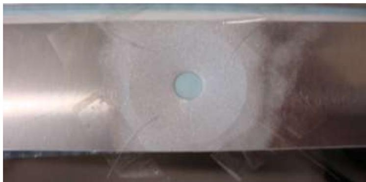
**Figura 18 - Substrato 3D sobre teflon e com fio de pesca para garantir a espessura.**
