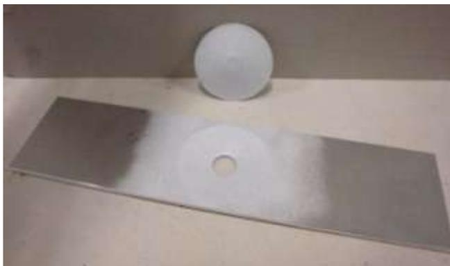
**Figura 17 - Provetes 3D e respetivo remendo após a granalhagem.**
