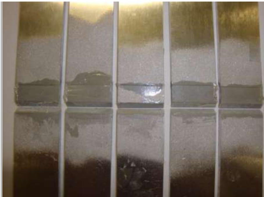
**Figura 57 - Superfície de ruptura para as reparações 2D com valores de  $\alpha$  igual a  $45^\circ$ , coladas com Araldite® 2015.**
