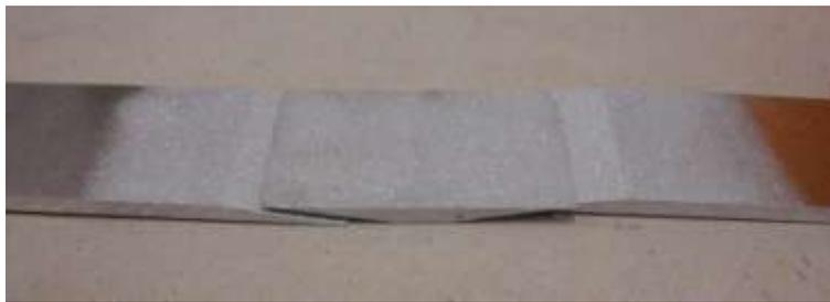
**Figura 11 - Substratos e remendo pós tratamento da superfície.**
