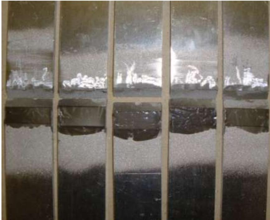
Figura 65 - Superfície de ruptura para as reparações 2D com valores de  $\alpha$  igual a  $30^\circ$ , coladas com Araldite® AV138.
