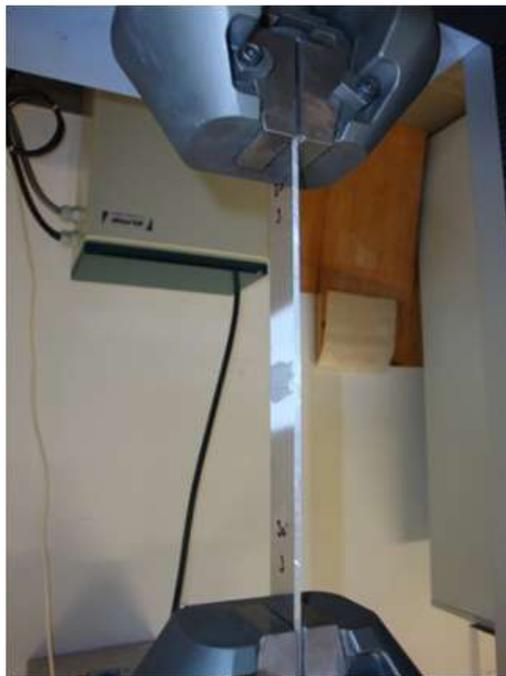
Figura 21 - Máquina Shimadzu – Autograph AG-X (a) e provete fixo nas maxilas da máquina de tração (b).
