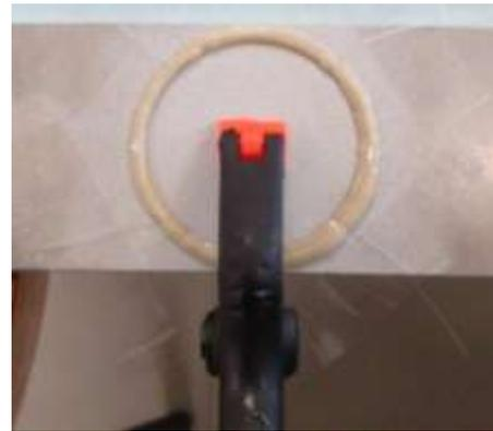
**Figura 19 - Substrato 3D após a aplicação do adesivo Araldite® 2015 (a) e Substrato 3D após a colocação do remendo (b).**
