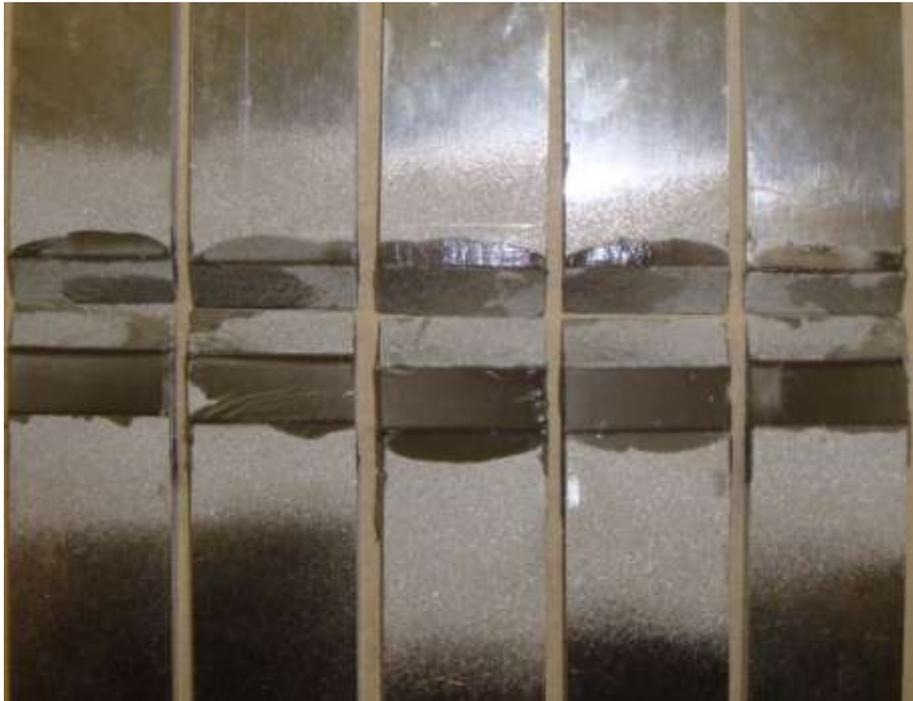
**Figura 63 - Superfície de rotura para as reparações 2D com valores de  $\alpha$  igual a  $20^\circ$ , coladas com Araldite® AV138.**
