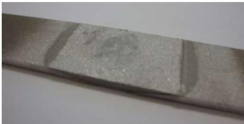
**Figura 15 - Aspeto final de um provete 2D.**
