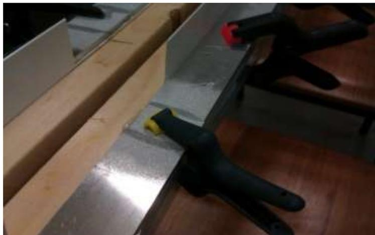
**Figura 14 - Provete após a aplicação do adesivo.**
