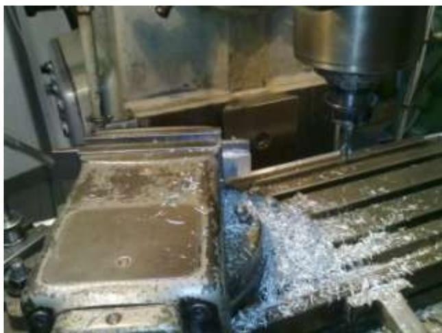
**Figura 10 - Processo de fresagem das rampas.**
