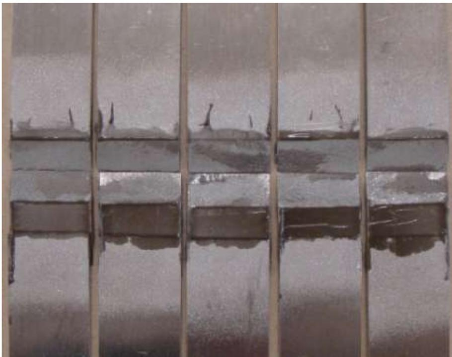
Figura 61 - Superfície de ruptura para as reparações 2D com valores de  $\alpha$  igual a  $15^\circ$ , coladas com Araldite<sup>®</sup> AV138.
