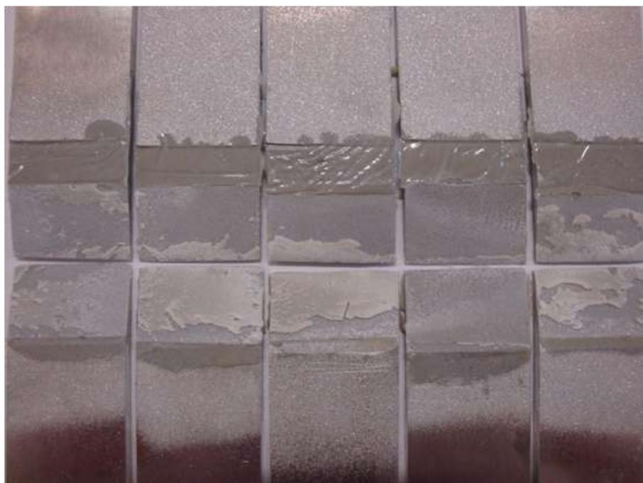
Figura 49 - Superfície de ruptura para as reparações com valores de  $\alpha$  igual a  $10^\circ$ , coladas com Araldite<sup>®</sup> 2015.
