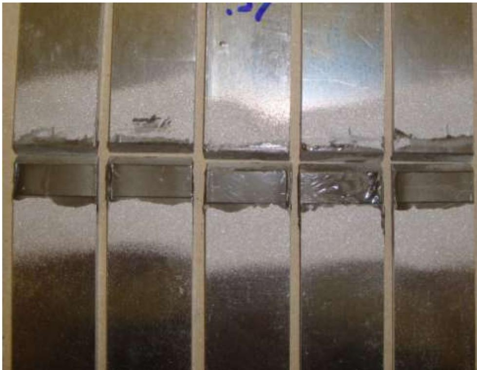
Figura 67 - Superfície de rotura para as reparações 2D com valores de  $\alpha$  igual a  $45^\circ$ , coladas com Araldite<sup>®</sup> AV138.
