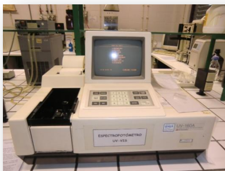
Figura 12 - Espectrofotómetro UV/Visível utilizado na avaliação do crescimento das culturas pelo método de densidade ótica.
