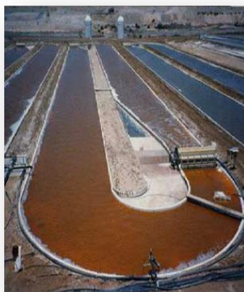
Figura 2 - Sistemas de produção abertos to tipo raceway pond (Gouveia, 2011).
