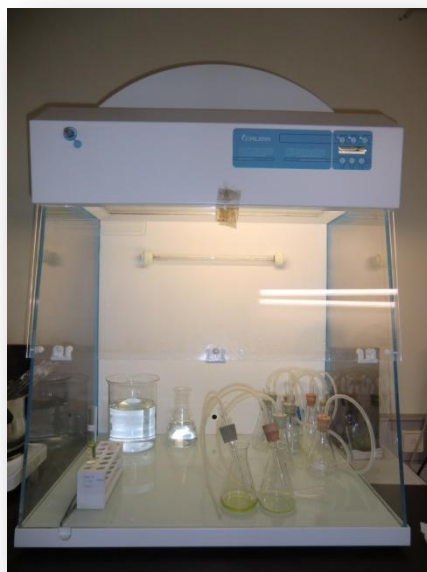
Figura 7 - Preparação dos sistemas de cultura em câmara de fluxo laminar.
