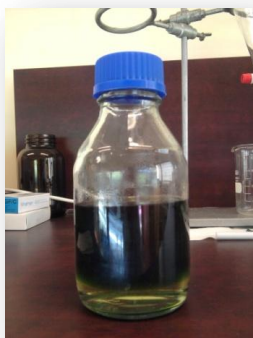
Figura 15 - Sistema bifásico formado durante o processo de extração de lípidos com uma mistura de hexano/isopropanol.
