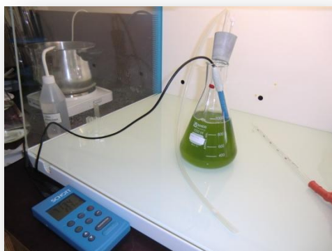
Figura 9 - Monitorização do pH e temperatura das culturas, em câmara de fluxo laminar.
