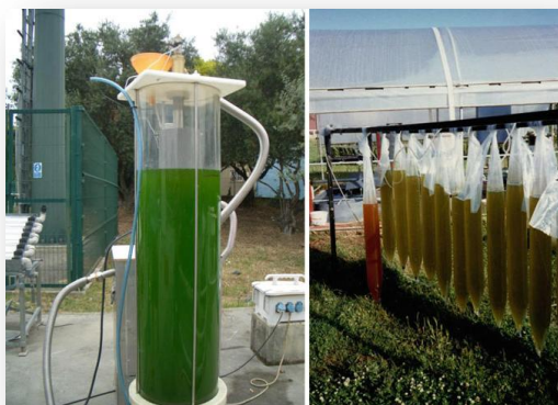
Figura 3 - Sistemas de produção em fotobioreactores de coluna vertical (Gouveia, 2011).
