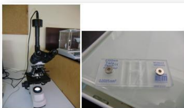
Figura 11 - Contagem celular no microscópio usando uma câmara de contagem de Neubauer.
