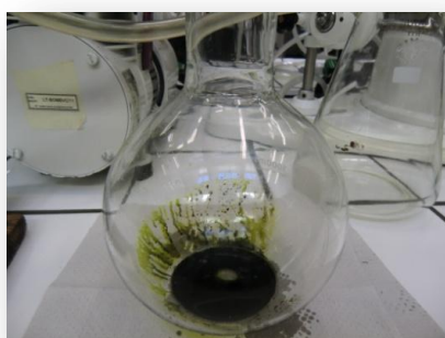
Figura 15 - Sistema bifásico formado durante o processo de extração de lípidos com uma mistura de hexano/isopropanol.
