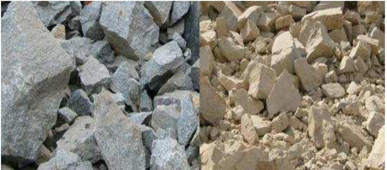
Figura 5 - Granito são (bancada interior) e granito amarelo alterado (bancada superior)
