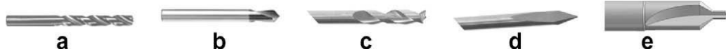
Fig. 2. Drills: (a) twist 120; (b) twist 85°; (c) Brad; (d) Dagger; and (e) step.
