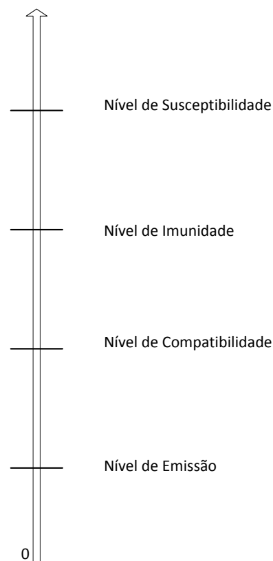
Fig. 3 Os vários níveis de perturbação para compatibilidade cargas não-lineares/equipamento sensível
