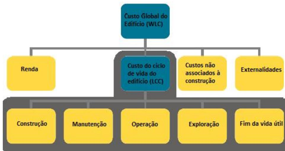
Figura 5 - Diferença entre WLC e LCC (adaptado a partir da norma ISO 15686-5)
