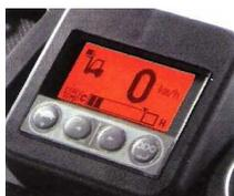
**Figura 59 : Display digital – limitador de velocidade de elevação**
