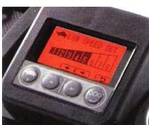
**Figura 61 : Display digital – limitador de velocidade de tracção**
