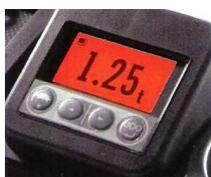
**Figura 60 : Display digital – indicação do peso de carga**
