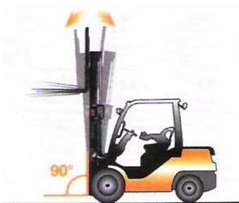
**Figura 58 : Nivelamento automático dos garfos**
