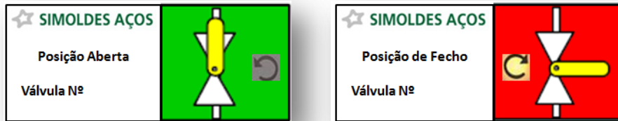
Figura 45 Indicadores sentido abertura de válvulas
