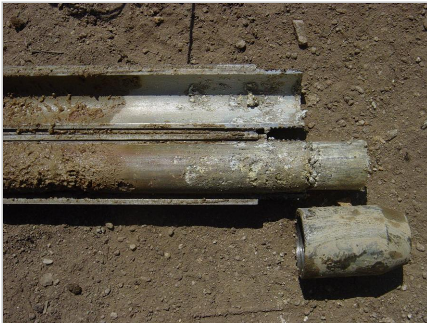
FIGURA 2.19 | RECOLHA E RECUPERAÇÃO DE AMOSTRA COM AMOSTRADOR TERZAGHI.
