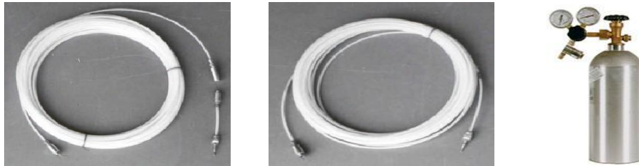
FIGURA 2.13 | ASPECTO DOS CABOS E-P E A FONTE DE GÁS PRESSURIZADO
