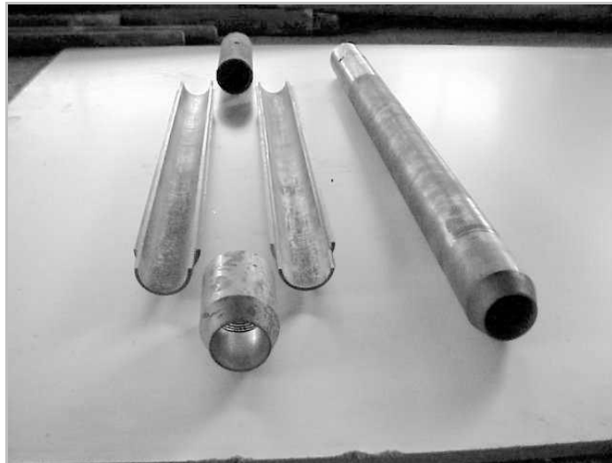
FIGURA 2.18 | AMOSTRADOR NORMALIZADO – TERZAGHI, CICCOPN
