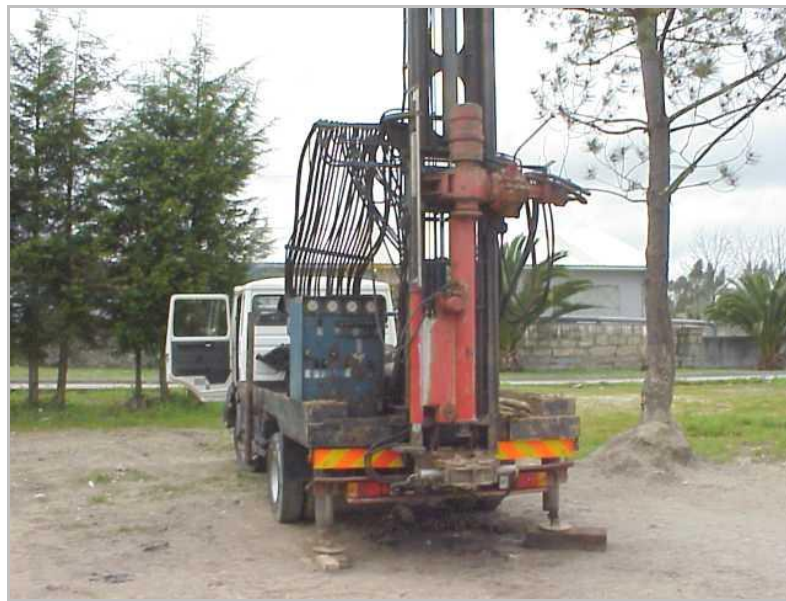
FIGURA 3.4 | SONDA DE PERCUSSÃO E ROTAÇÃO (CIBELLES 60), CICCOPN.
