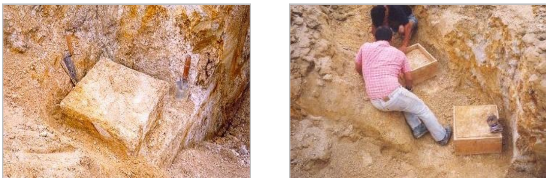
FIGURA 1.4| TALHAGEM E RECOLHA DE AMOSTRAS EM BLOCOS (MATOS FERNANDES, 1995).
