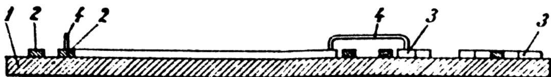
Figura 6 - Circuito desenvolvido por Parolini, com implementação de jumpers.
