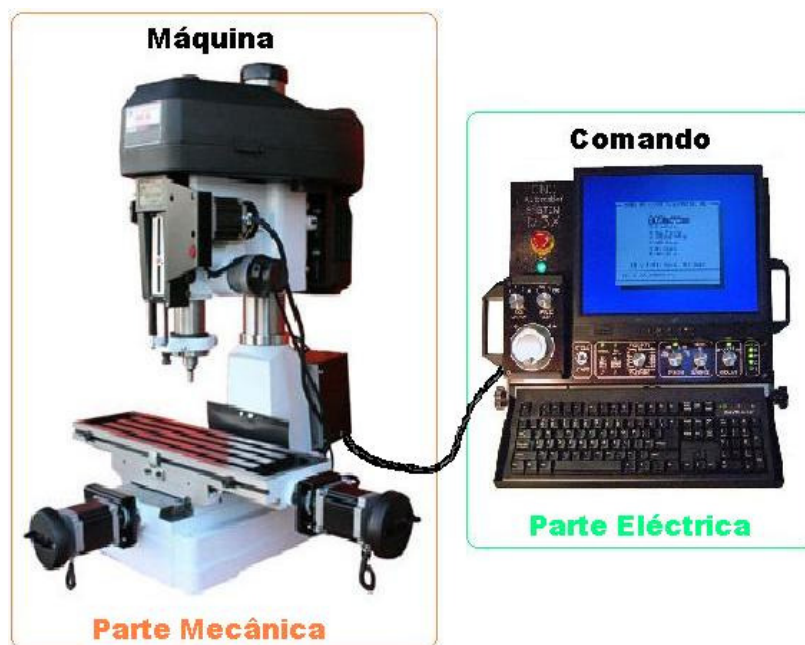
Figura 22- Constituição básica de uma máquina CNC
