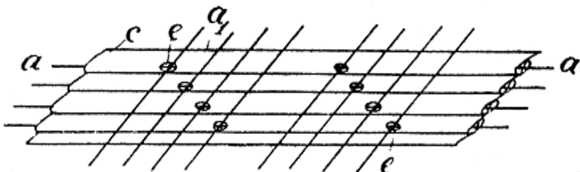
Figura 2- Esquema de conexões por Albert Hanson.
