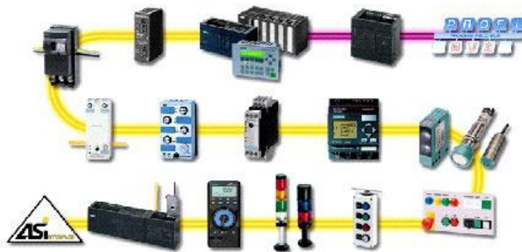
Figura 10 Estrutura funcional AS-Interface
