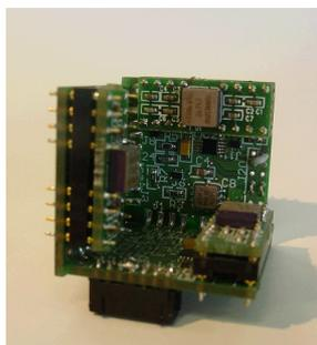
Figura 3.5: Sistema INS embebido
