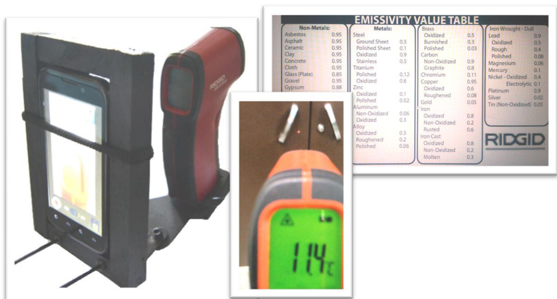
Figura 28 - Criação de um suporte para usar a câmara do telemóvel mais o equipamento de medição térmica.
