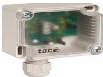
O SLO320 transmissor de luz eletrônico converte uma medida lux em uma corrente elétrica (4 a 20 mA) ou sinal de tensão (0 a 10V). Eles têm duas faixas de sensibilidade para se adequar os níveis de luz diferentes:
