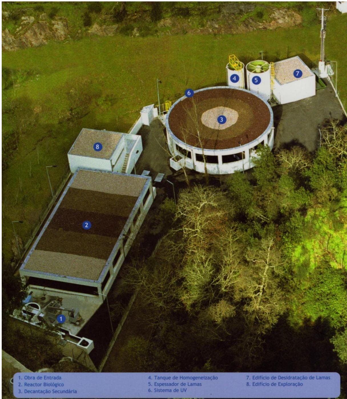
Figura 1.7 - Vista aérea da ETAR de Crestuma (fonte: Águas de Gaia, 2007e)
