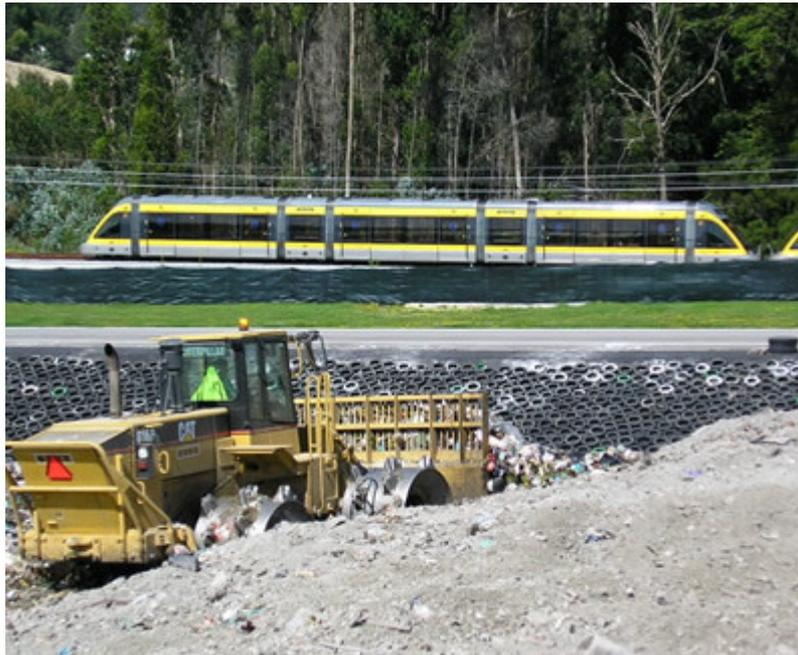
**Fig. 31** - Compactador pés de carneiro com lâmina de arrasto [10]
