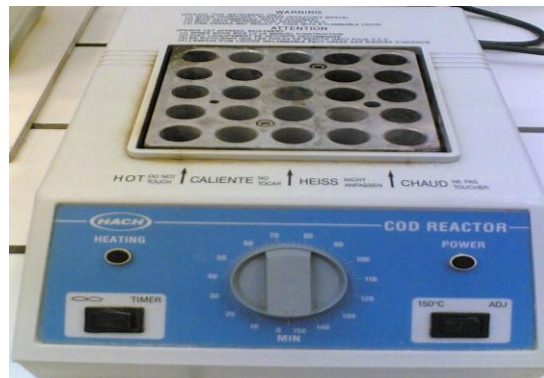
Figura A 5 – Digestor da CQO; Hach COD reader
