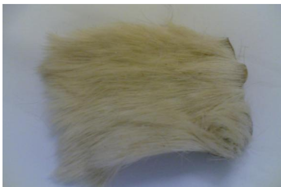
Figura 3. 2- Pele caprina antes e depois da depilação através do processo sem enzimas
