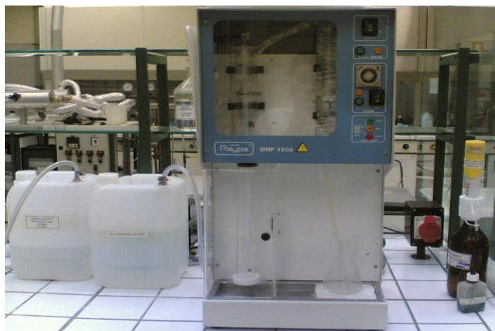
Figura A 8 – Destilador para determinar o Azoto Kjeldahl
