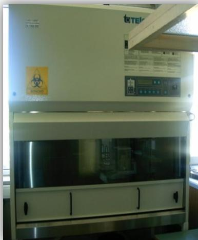
**Figura 2. 5.** Câmara de fluxos laminar com UV.
