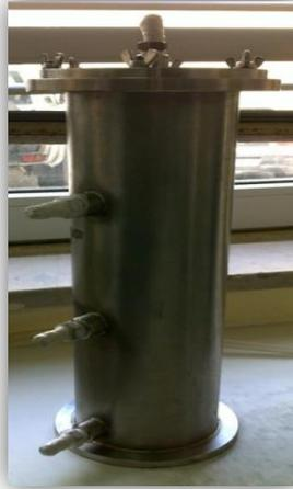
**Figura 2. 3.** Coluna de aço inoxidável utilizada nos ensaios.
