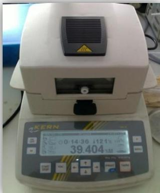
**Figura 2. 2.** Balança de humidade.
