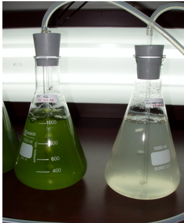
Figura III.7 – Culturas de Chlorella vulgaris em regime autotrófico (à esquerda) e em regime mixotrófico com a adição de 4,0 \text{ g}_{\text{glucose}}/\text{L}_{\text{meio}} (à direita) ao fim de 3 dias de cultivo.
