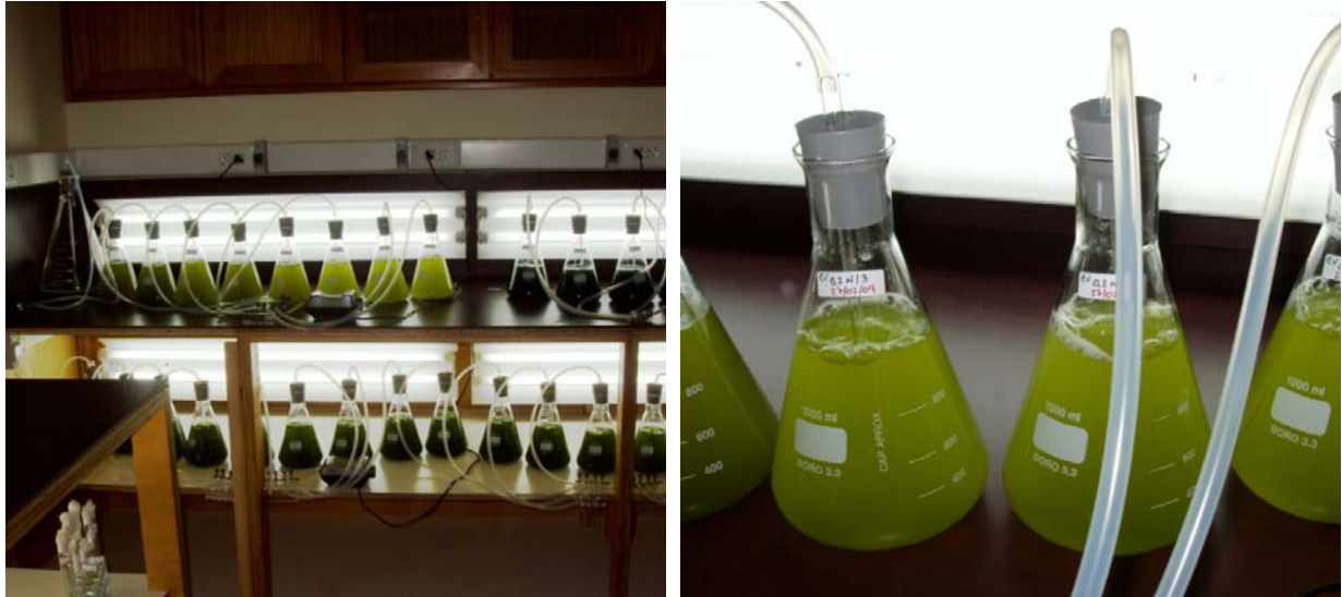
Figura III.12 – Culturas de Chlorella vulgaris em regime mixotrófico 1,0 g glucose /L meio : com diferentes percentagens de subtracção de azoto (à esquerda) e com subtracção da fonte de azoto em 80% (0,2N) (à direita).
