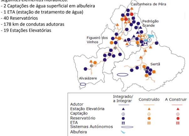
A captação e a ETA do Cabril alimentam o sistema de abastecimento de água de Cabril e foi construída em 2003/2004. O trabalho realizado integrou-se numa empreitada geral de concepção, construção e exploração e abrangeu a captação de água no rio Cabril, a ETA e a elevação inicial para o primeiro reservatório da rede adutora.
