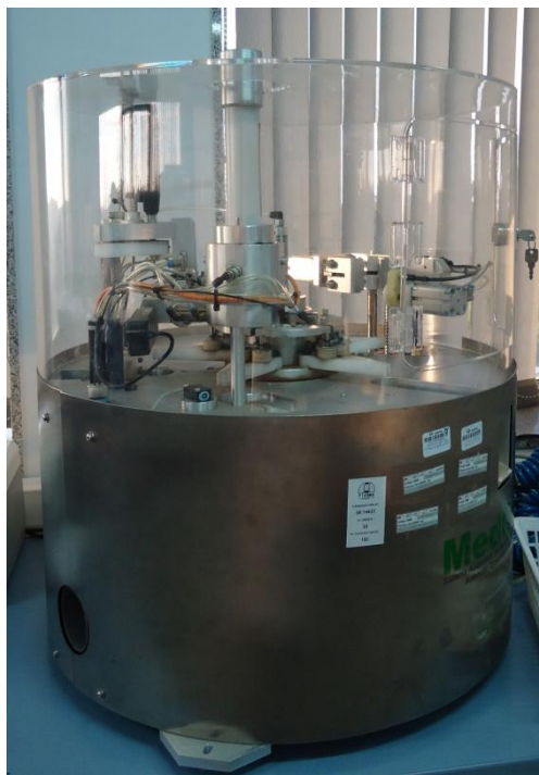
Figura M.1- Aparelho para determinar a massa volúmica aparente.
