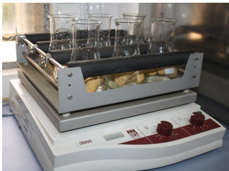
Figura M.7- Aparelho para determinação de peróxido nas rolhas.
