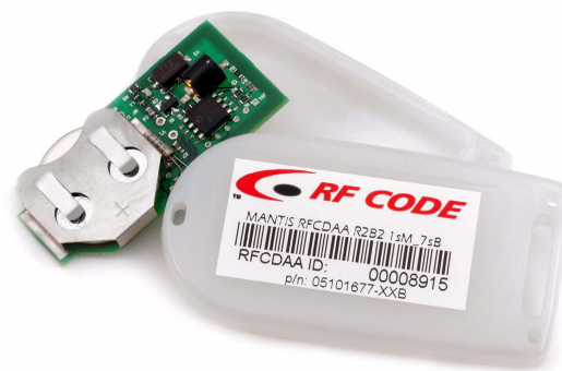
Figura 3.3 – Exemplo de uma tag activa [3]
