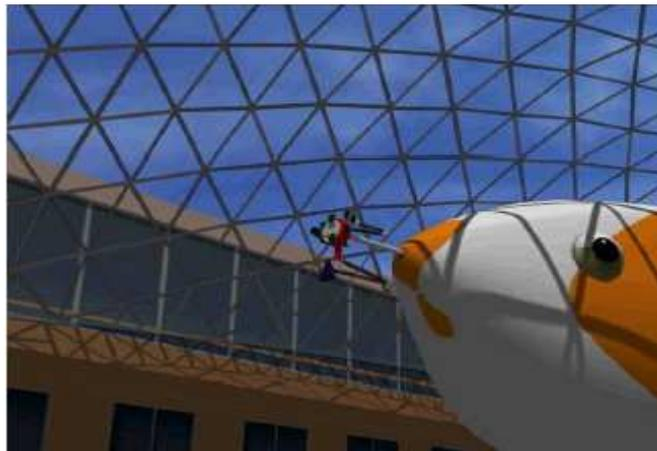
**Figura 47 Robô trepador equipado com um balão a hélio, que consiste num mecanismo de locomoção e numa ferramenta de limpeza (fonte: Elkmann, *et al.*, 2002)**
