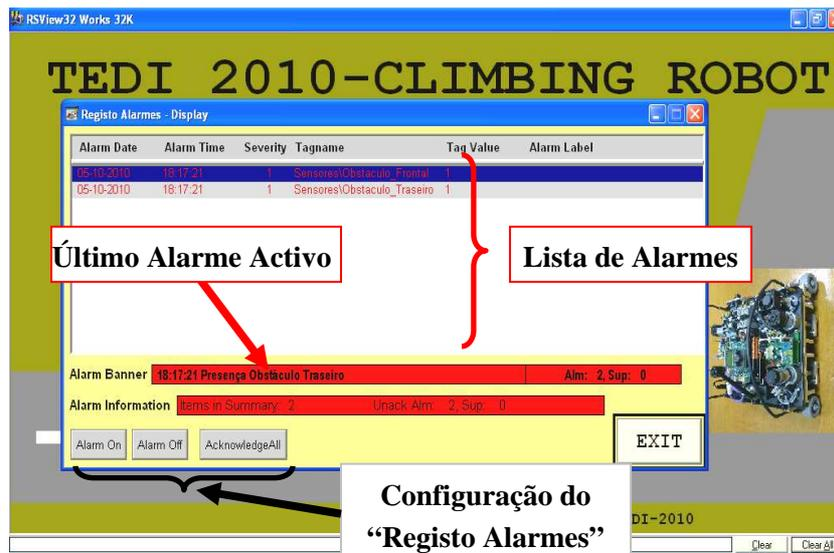
Figura 115 Gráfico/Display HMI “Registo Alarmes”
