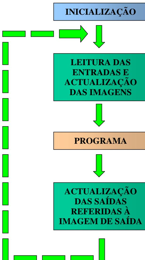
Figura 103 Ciclo de processamento do PLC
