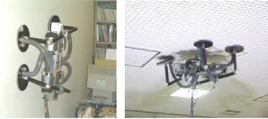
**Figura 15** Robô Hyperion a deslocar-se numa parede (à esquerda) e num tecto (à direita) (fonte: Yoneda, *et al.*, 2001)
