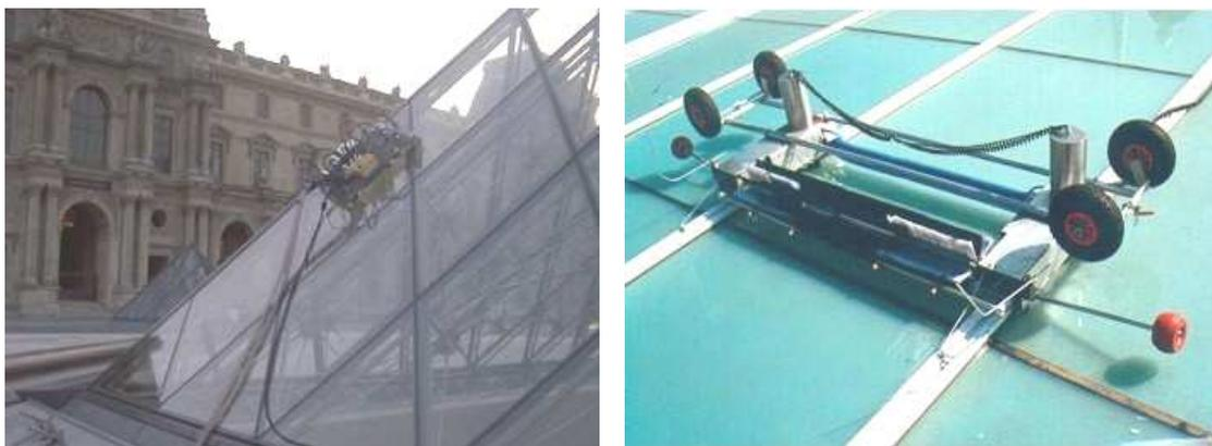
**Figura 1** Robô trepador a efectuar a limpeza da pirâmide de vidro no Museu do Louvre, em Paris, (à esquerda) e robô trepador a efectuar a limpeza da cobertura de vidro do Grand Stade de France (à direita) (fonte: Robosoft, 2010)
