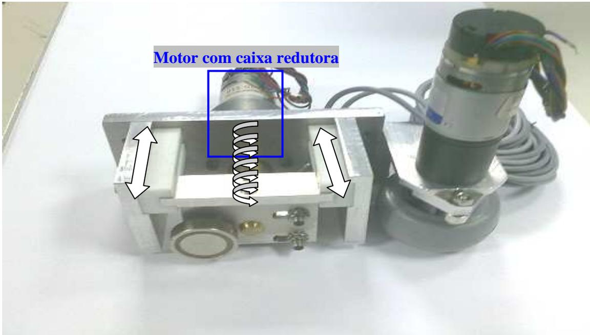
Figura 58 Base deslizante do Sistema de Adesão, com o ímã permanente (à esquerda) e os sensores indutivos (à direita)
