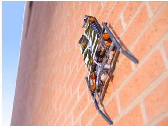
**Figura 46 Robô trepador a subir uma parede de tijolo recorrendo à electroadesão (fonte: SRI International, 2010)**
