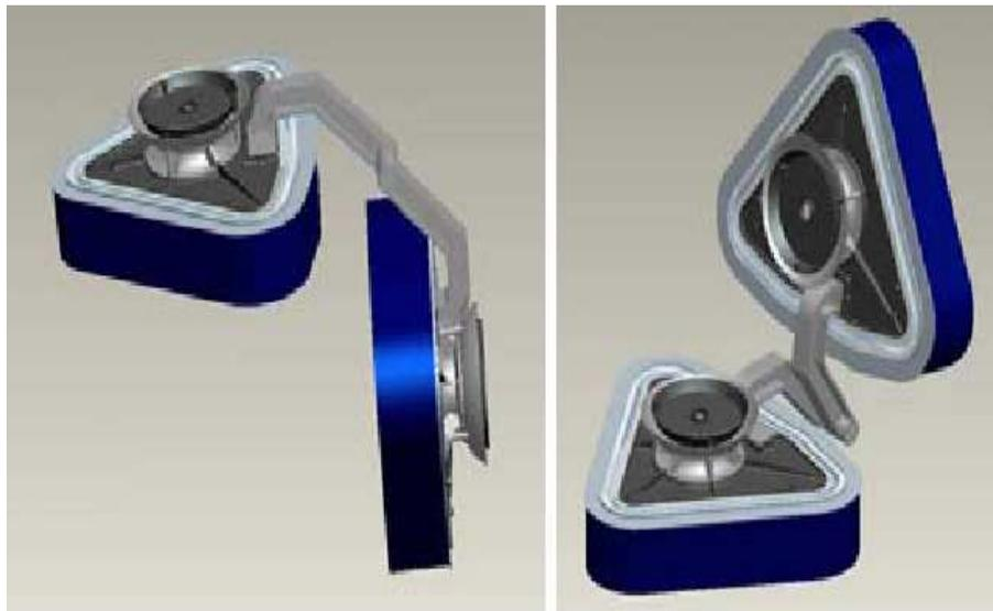
**Figura 24** Dois módulos do robô trepador City-Climber II, ligados por uma junta, nas configurações  $+90^\circ$  e  $-90^\circ$ , capazes de efectuarem transições entre diferentes paredes (à esquerda) e entre uma parede e o tecto (à direita) (fonte: Elliot, *et al.*, 2006)
