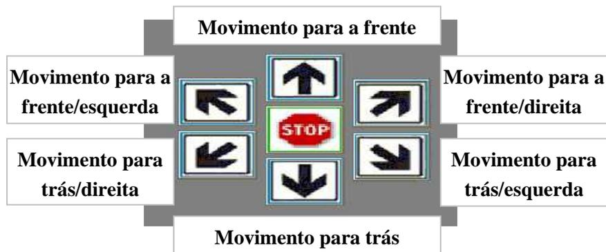
**Figura 121** Pormenor das teclas de controlo da direcção da locomoção no Gráfico/Display HMI “Manual Locomoção”
