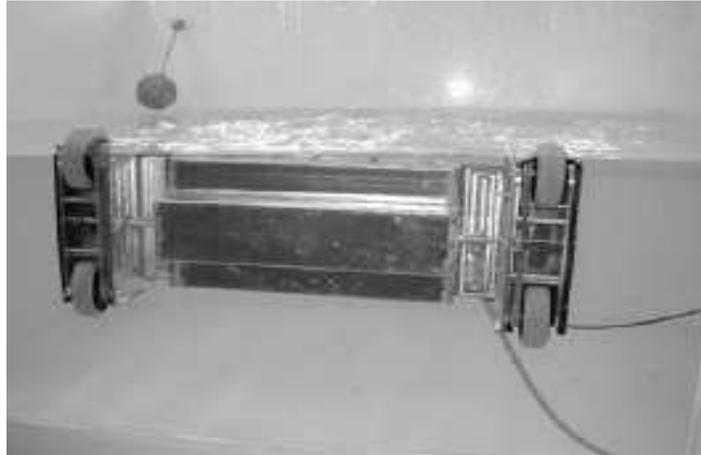
**Figura 35 Robô trepador subindo a parede de vidro de um tanque, sem qualquer reservatório de flutuação (fonte: Sattar, *et al.*, 2006)**
