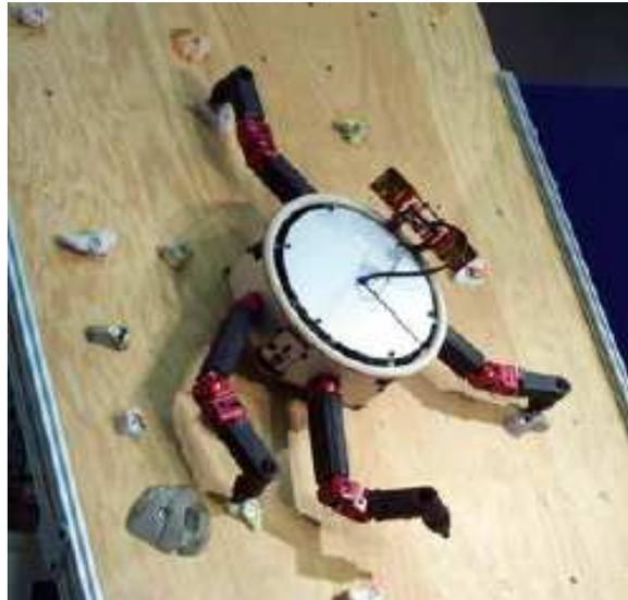
**Figura 30** Robô LEMUR Iib trepando uma parede de testes (fonte: Kennedy, *et al.*, 2006)
