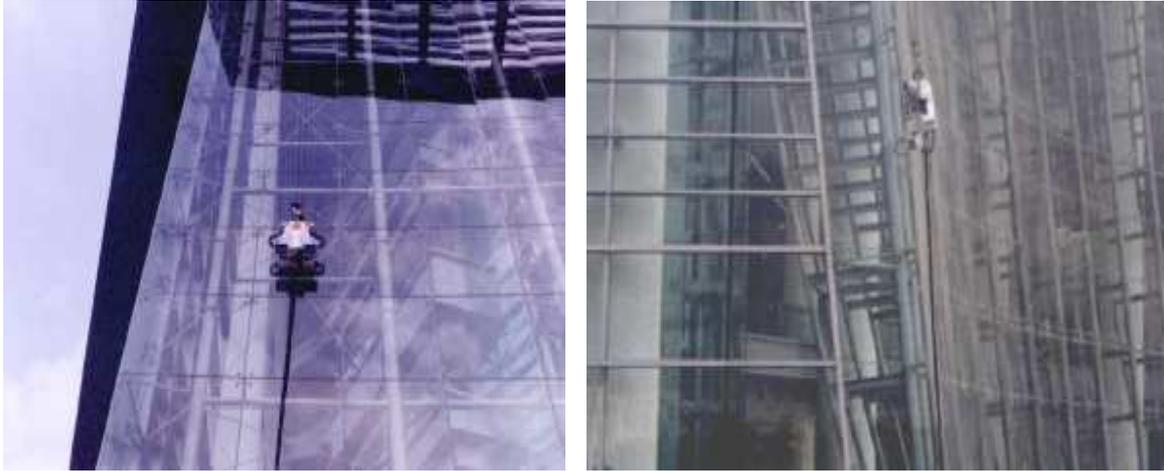
**Figura 4** Fotografias do robô trepador Skycleaner a efectuar a limpeza das superfícies exteriores envidraçadas no edifício do Museu de Ciência e Tecnologia de Shanghai (fonte: Zhang, *et al.*, 2004)
