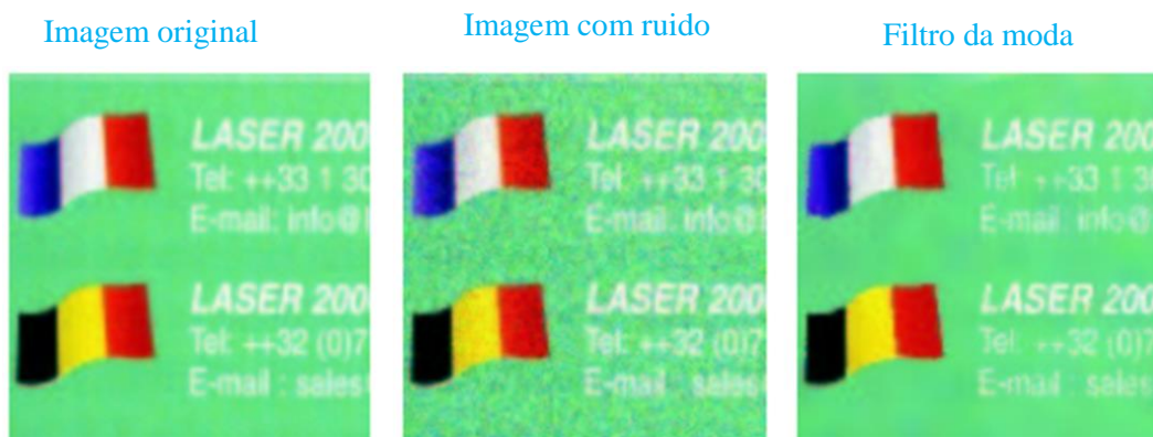
Figura 2.28 – Exemplo de aplicação de filtro da moda a imagem com ruído (adaptado de[22]).
