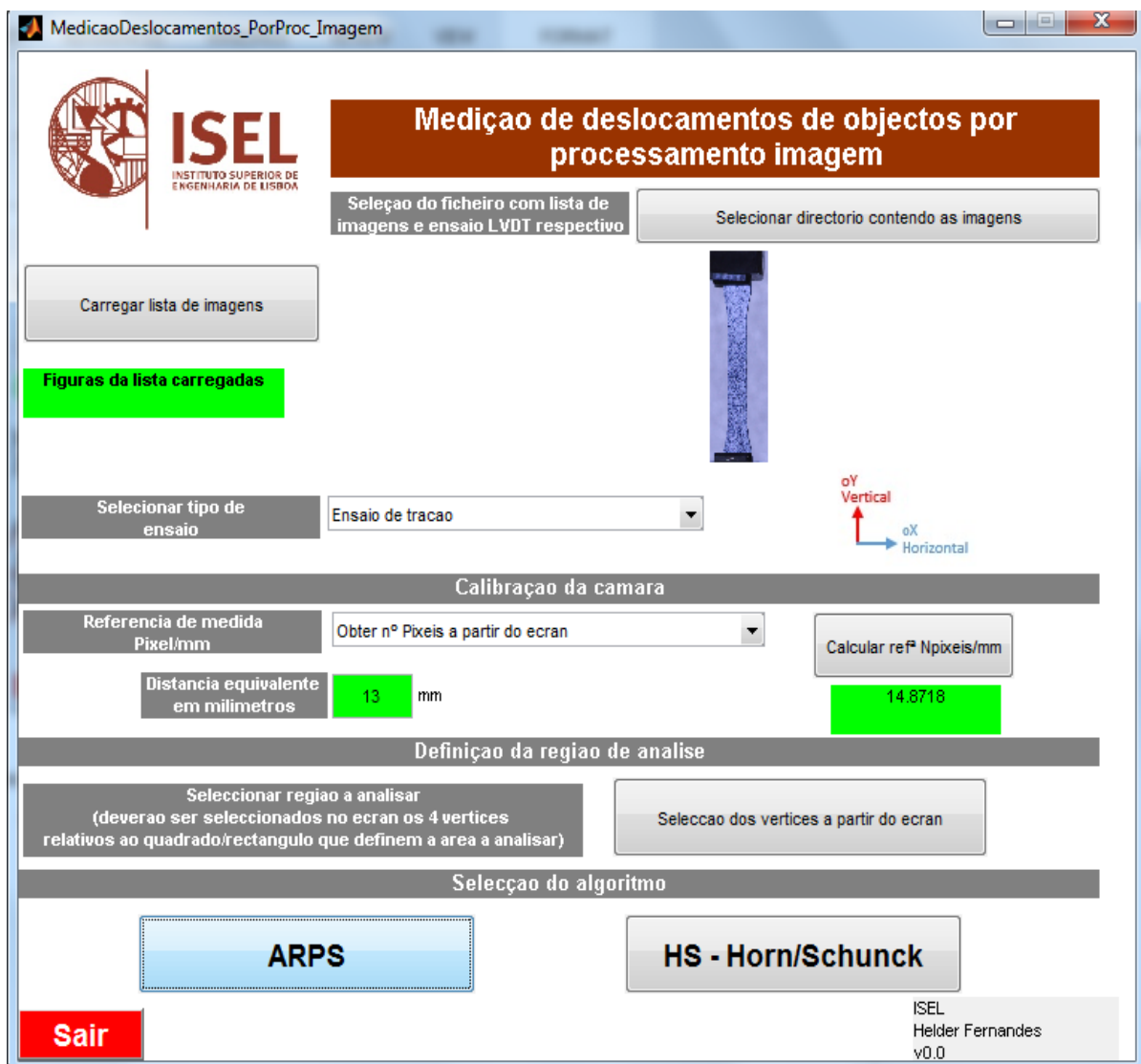
Figura 4.3 – Aspeto visual da janela de seleção de dados, calibração de camara, definição da ROI após preenchimento dos campos obrigatórios.
