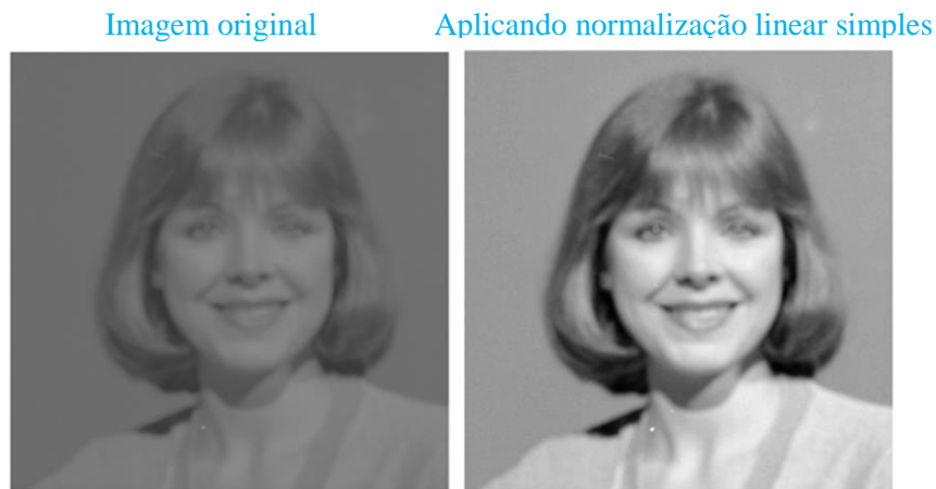
Figura 2.19 – Exemplo de normalização de contraste (adaptado de[14]).
