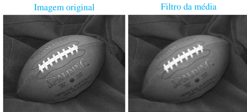
Figura 2.26 – Exemplo de aplicação de filtro da média a imagem em tons de cinzento.
