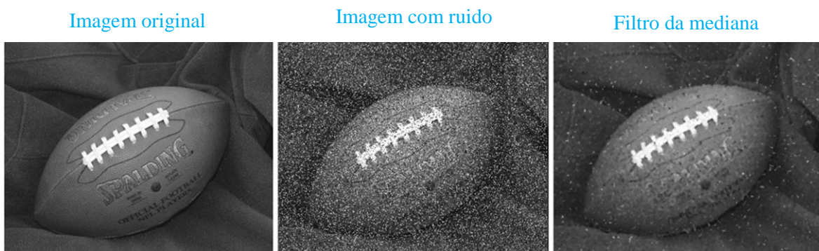
Figura 2.27 – Exemplo de aplicação de filtro da mediana a imagem com ruído.
