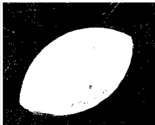
Figura 2.23 – Exemplo da imagem convertida em tons de cinza e da tonalidade monocromática encarnada da imagem original com base num limiar de 50.
