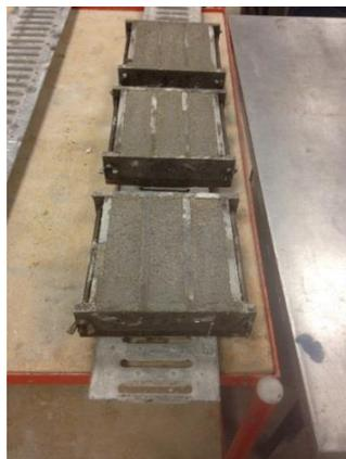
Figura 3.13-Provetes antes da desmoldagem
