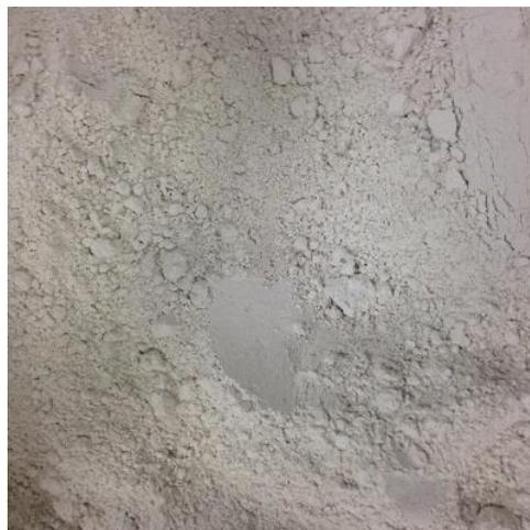
Figura 3.4- Resíduo cerâmico vidrado (azulejos após o processo de desgaste)
