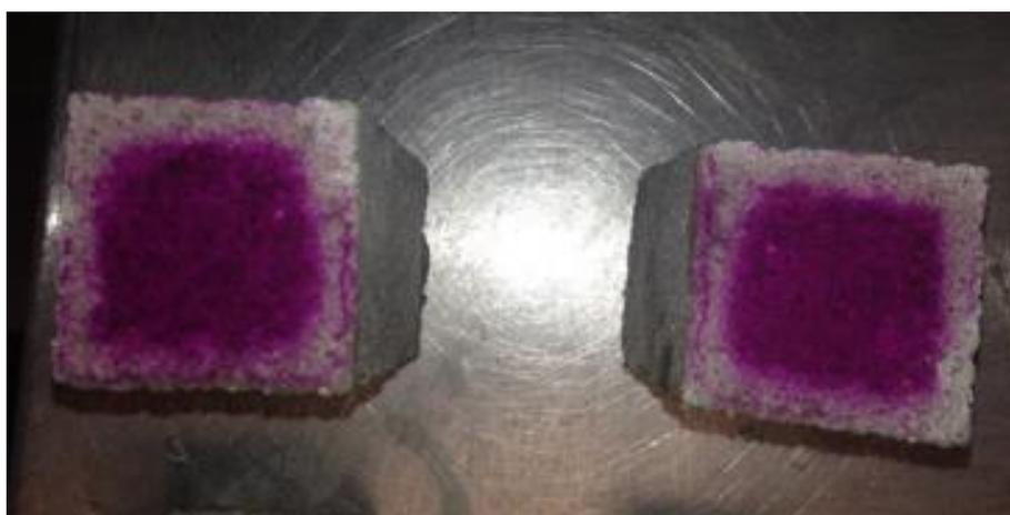
Figura 4.24- Profundidade de carbonatação aos 60 dias
