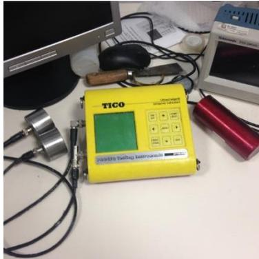
Figura 3.18-Aparelho de emissão de ondas ultrassônicas marca Proceq
