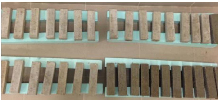
Figura 3.14- Provetes com diferentes idades de cura
