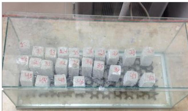
Figura 3.23-Provetes durante o ensaio de absorção de água
