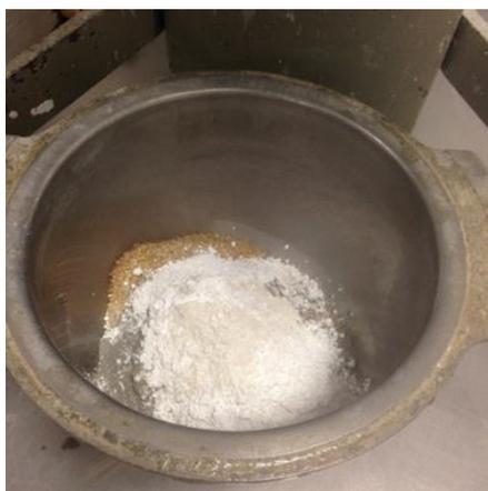
Figura 3.10-Copo da misturadora com constituintes secos das argamassas
