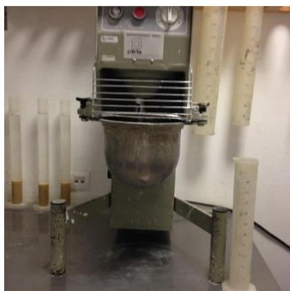
Figura 3.9- Misturador mecânico de argamassas e proveta graduada
