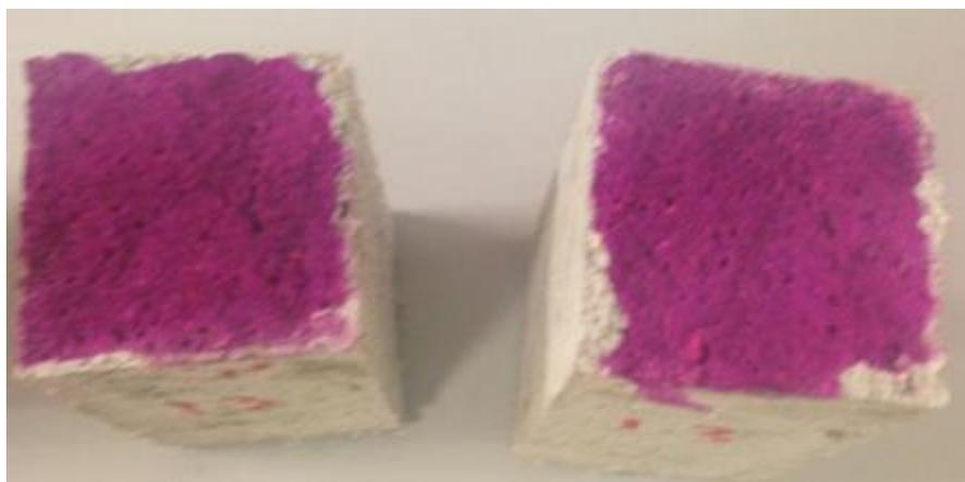
Figura 4.23- Profundidade de carbonatação aos 28 dias.
