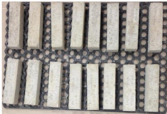
Figura 3.16- Provetes na sala de cura
