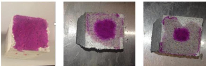
Figura 4.26- Provetes onde se realizou o ensaio de carbonatação
