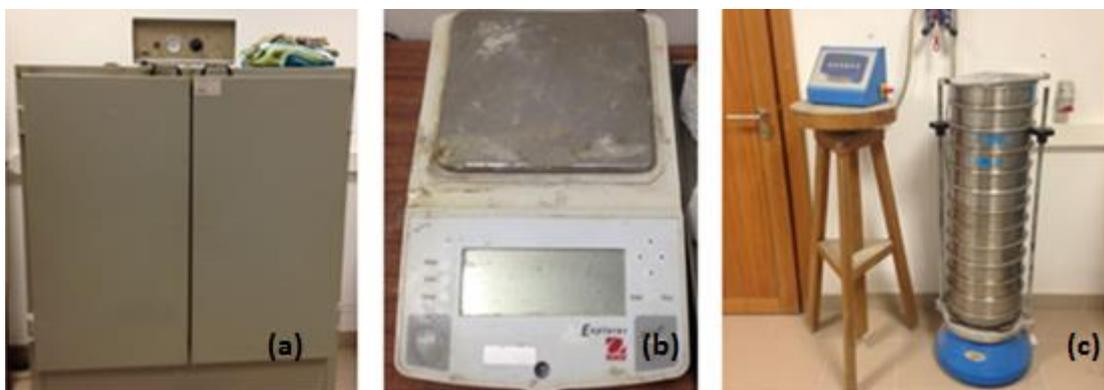
Figura 3.7-(a)Estufa, (b)Balança digital precisão 0,01g e (c)série de peneiros A200
