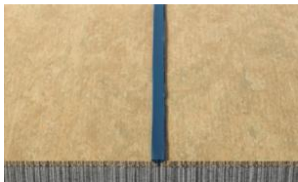
Figura 32 – Cordão de soldadura após redução [24].
