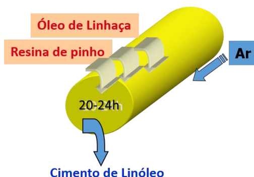
Figura 15 - Oxidação do óleo de linhaça com a resina de pinho (adaptada de [8])
