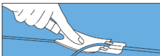
Figura 31 - Redução do cordão de soldadura [29]
