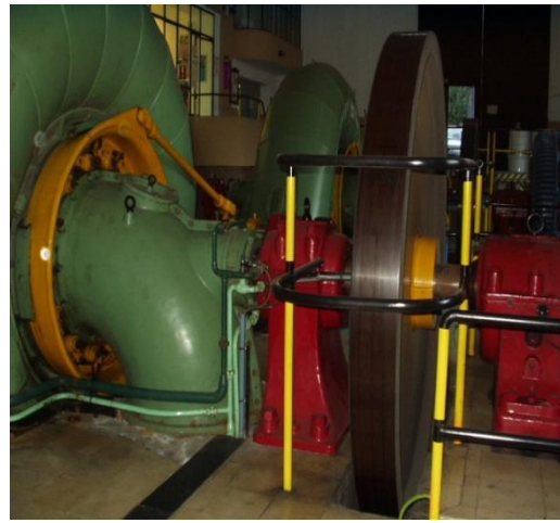
Figura 2.2 – Volante de inércia, utilizado numa turbina hidráulica.
