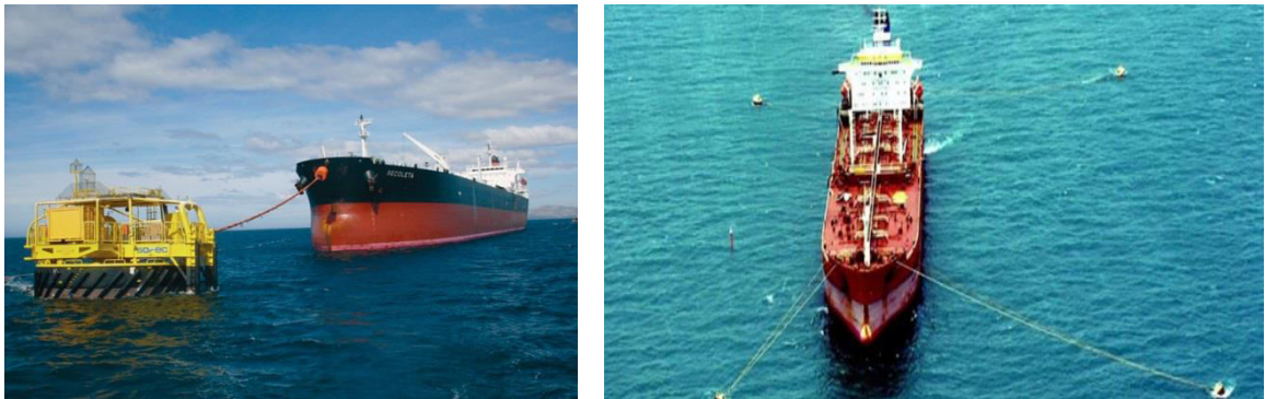
Figura 3-17 - Sistema SPM e CBM, respetivamente (Fonte: MarineInsight; PMI)
