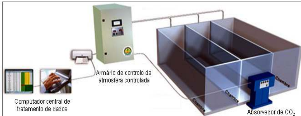
Figura 36: Equipamento de controlo e gestão dos níveis de gases (adaptado de [32]).
