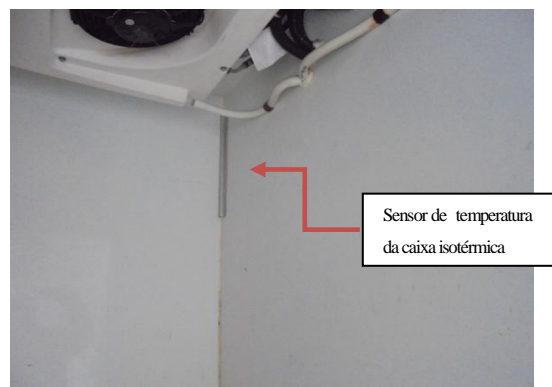
Fig. 17. Sensor temperatura no interior da caixa isotérmica
