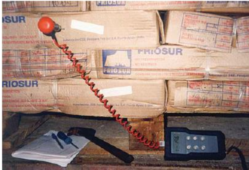
Fig 5 - Medida da temperatura do produto embalado em cartão
