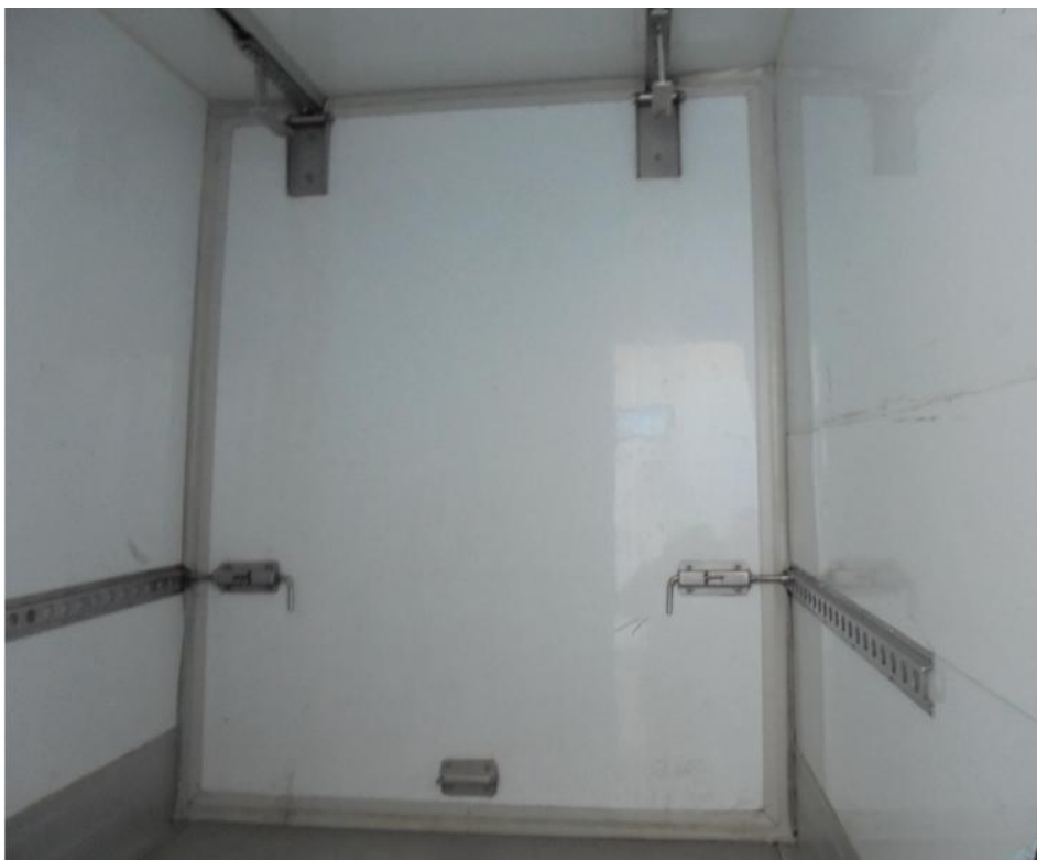
Fig. 6 - Calhas laterais para deslocamento da divisória
