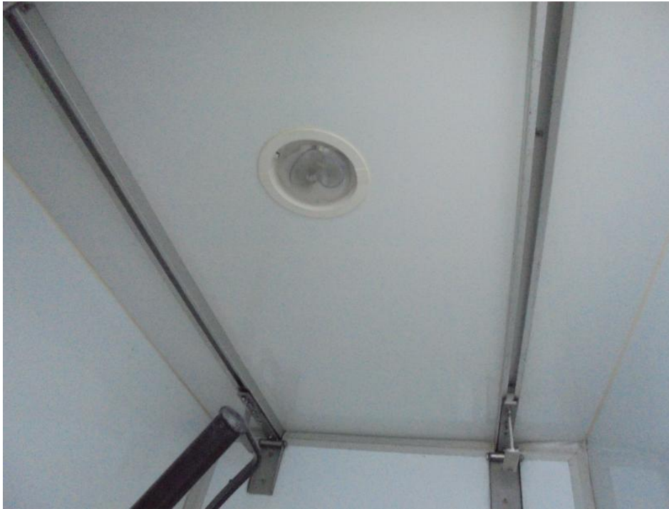
Fig. 5 - Calhas no teto da viatura para deslocamento da divisória
