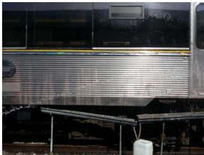
Figura 40 – Projecção de água para limpar a superfície
