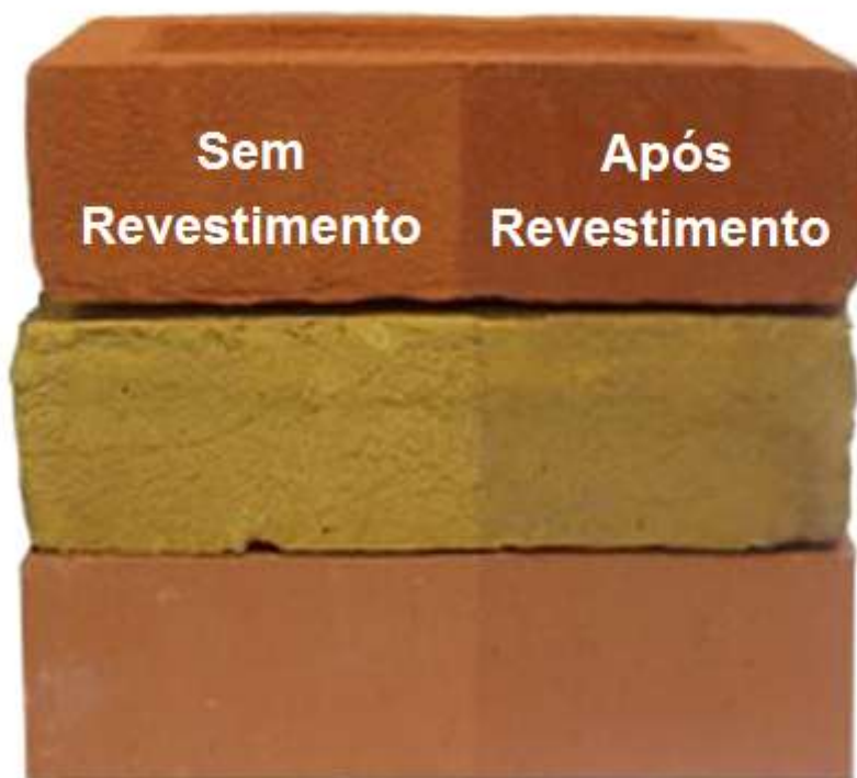
Figura 43 – Diferença entre uma parede já com revestimento anti-graffiti permanente com aspecto baixo e sem qualquer revestimento [6]
