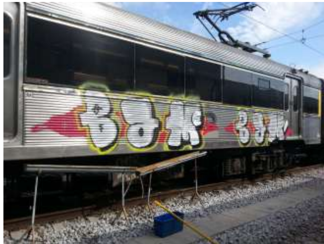
Figura 37 – Colocação de umas caleiras de escoamento dos líquidos
