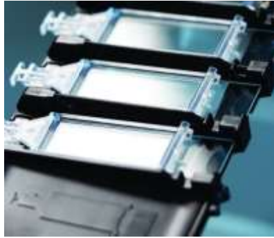
Figura 105 - Leica Bond III - covertiles colocados na superfície das lâminas.
