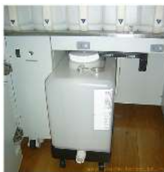
Figura 101 - Ventana Ultra - recipiente de recolha de detritos líquidos.
