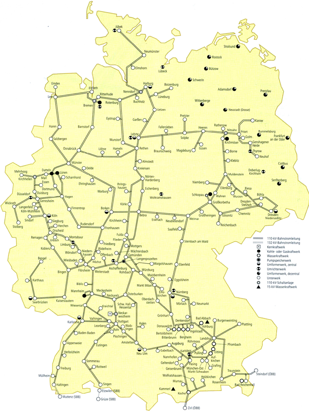
16,7-Hz-Energieerzeugungs-, übertragungs- und verteilungsanlagen in Deutschland am 1. Januar 2011
