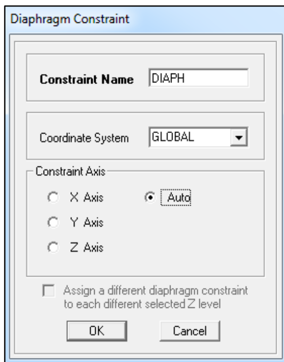
Figura 2.7 – Bloqueio dos nós da laje
