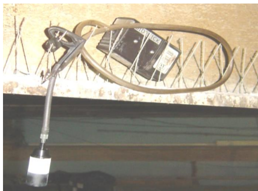
Foto 6 - Aparelho de monitorização, num processo de recolha de fibras de amianto em suspensão.
