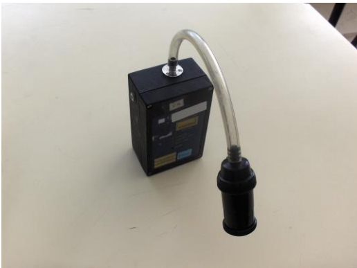
Foto 4 - Aparelhos para monitorização, com bomba e filtros, para recepção das fibras em suspensão.
