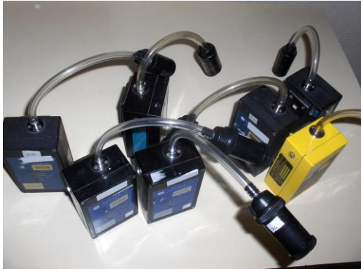
Foto 3 - Aparelhos para monitorização e avaliação da zona da cobertura, antes dos trabalhos iniciarem, para determinar a concentração de amianto no ar.
