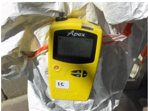
Foto 54 – Aparelhos para monitorização aplicado num trabalhador, para determinar a concentração de amianto no ar, durante a execução dos trabalhos.
