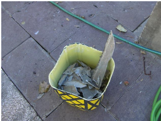
Foto 80 – Restos de fibrocimento em balde, permitindo a libertação de fibras.
