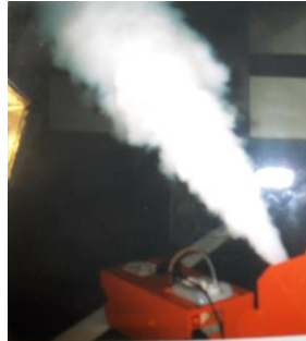
Figura 6 – Ensaio de fumos para verificar a estanquidade do sistema
