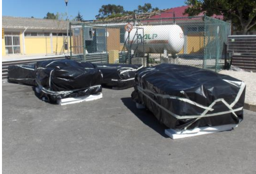
Foto 70 – Chapas de fibrocimento embaladas, mas sem símbolo de amianto.
