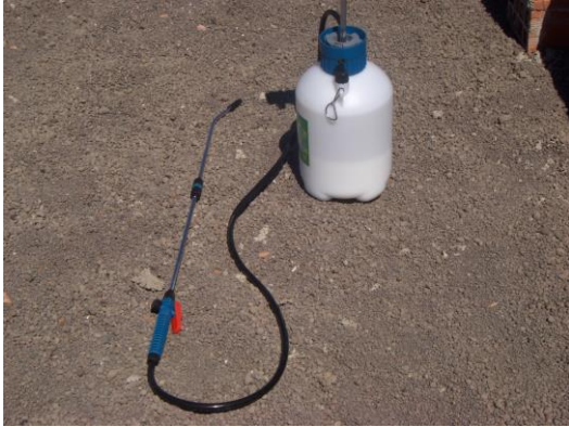
Foto 31 – Remoção de fibrocimento pelo exterior. Pulverizador para aplicação da solução aquosa para o encapsulamento.
