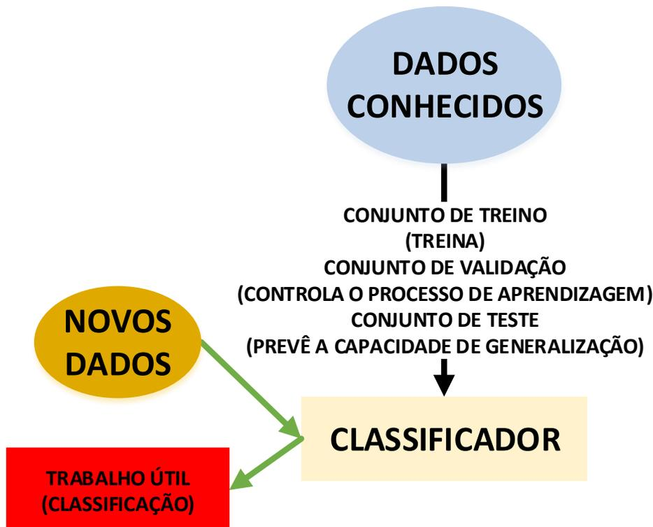
Figura 41 – Classificador – Esquema geral de funcionamento.
