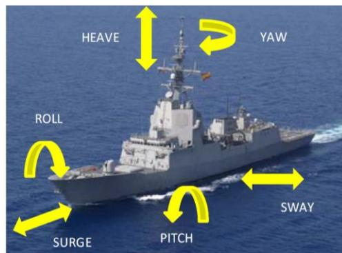
Figura 78 – Movimentos padrão de um navio – eixos de rotação e translação (Riola, Diaz et al. 2011).
