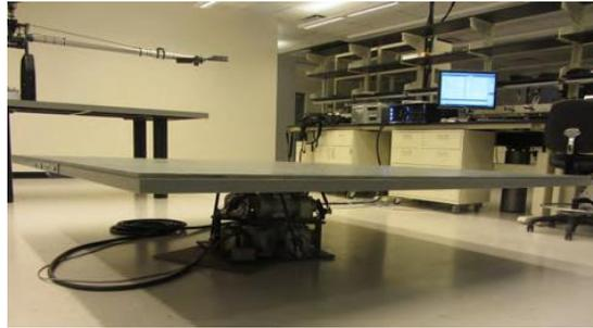
Figura 80 – Plataforma de 6 graus de liberdade – Simulação de um navio (Sanchez-Lopez, Saripalli et al. 2013).
