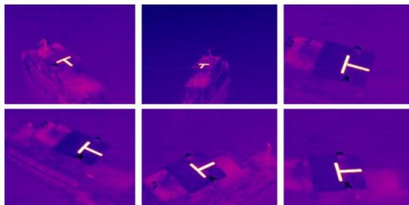
Figura 82 – Imagens infravermelhos de um exemplo de marcador usado no convés de voo de um navio (Xu, Zhang et al. 2009)
