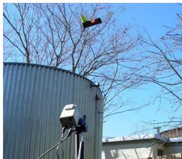
Figura 76 – Exemplo de sistema baseado em terra – visão estereoscópica espectro visível (Hazeldene, Sloan et al. 2004).
