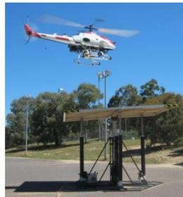
Figura 79 – Exemplo de outro tipo de plataforma de 6 graus de liberdade – Simulação de um navio (Garratt, Pota et al. 2009).
