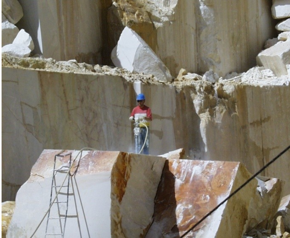
Fig. 4.3 – Cabouqueiro com martelo pneumático (Fonte: Autora)
