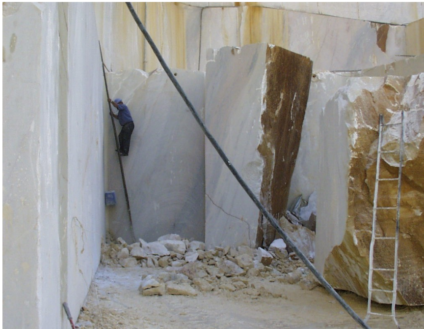
Fig. 5.5 – Acesso ao fundo da pedreira por meio de escada móvel (Fonte: autora)
