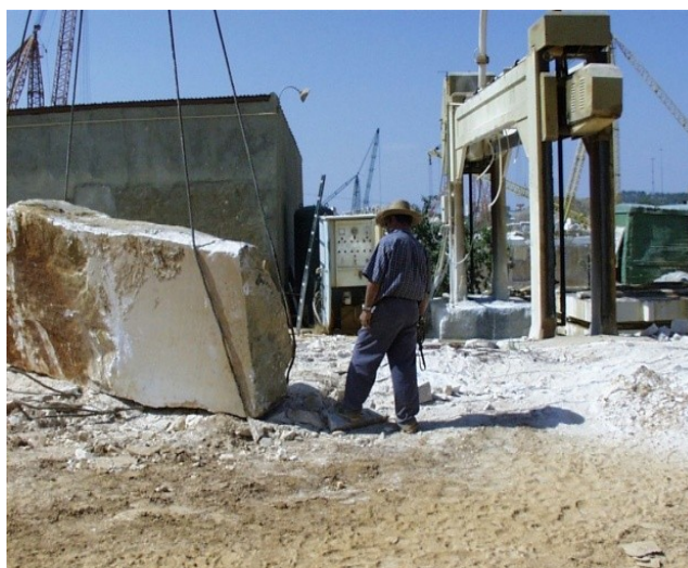
Fig 4.10 – Serrador e bloco primário (Fonte: Autora)
