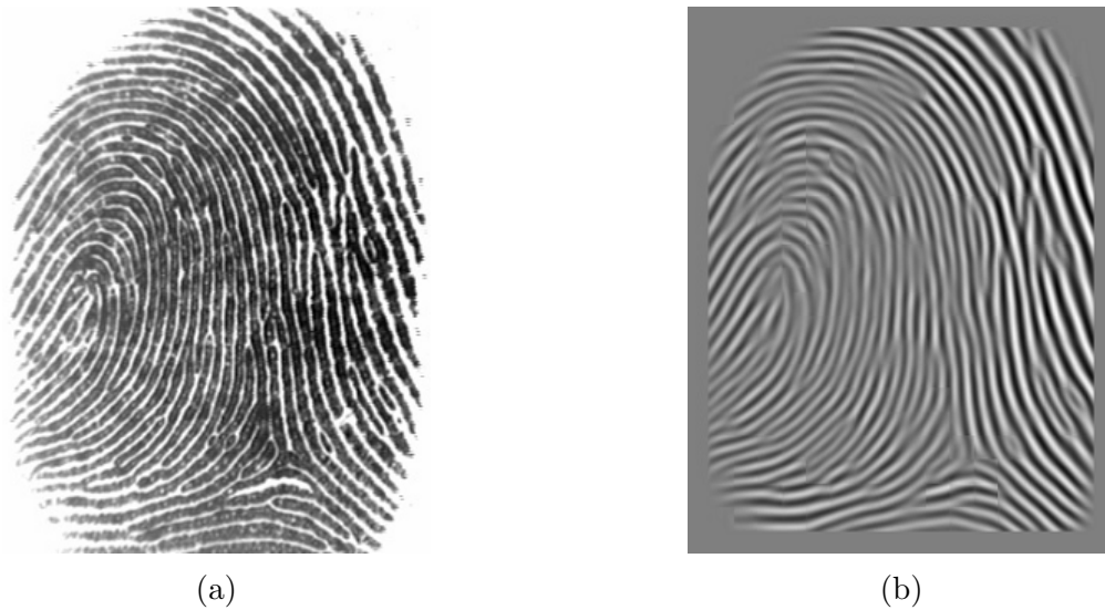
Figura 3.3: Melhoramento de impressões digitais através de filtros de Gabor: (a) impressão digital original, (b) impressão digital após melhoramento [27].
