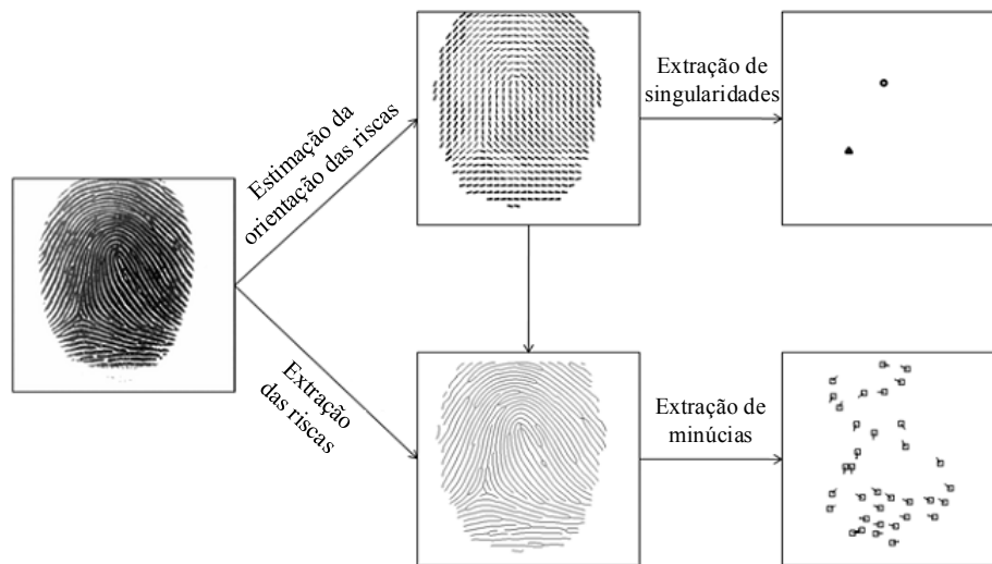
Figura 3.1: Diagrama de blocos do processo de extração de características (minúcias) (adaptado de [27]).
