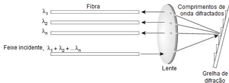
Figura 7 – Dispositivo baseado em grelhas de difração [6] (adap.).
