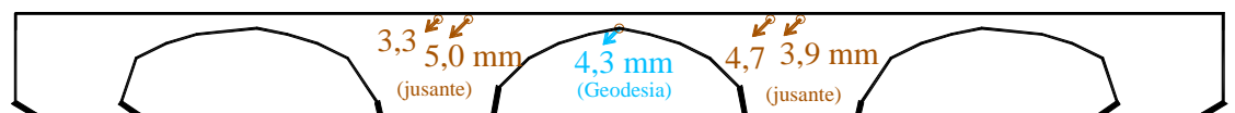
Figura 4.20 – Deslocamentos radiais medidos por fios de prumo nos pontos à cota 123,8 m. Resultados de síntese referentes à análise comparativa MSE/MEF.
