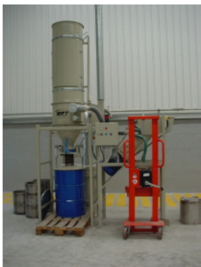
Figura 14: Triturador de lâmpadas de geometria diversa (Fonte: Unidade de reciclagem de lâmpadas fluorescentes).
