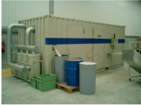
Figura 8: Triturador separador de lâmpadas fluorescentes tubulares (Fonte: Unidade de reciclagem de lâmpadas fluorescentes).
