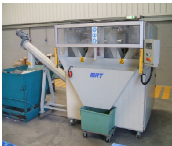
Figura 12: Processador de lâmpadas de alta densidade (Fonte: Unidade de reciclagem de lâmpadas fluorescentes).
