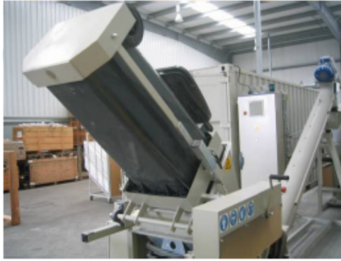
Figura 10: Pré tratamento de lâmpadas fluorescentes circulares e compactas (Fonte: Unidade de reciclagem de lâmpadas fluorescentes).
